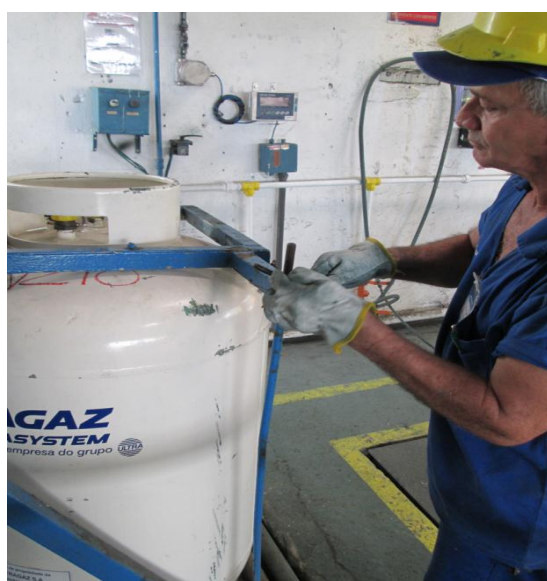
Figura 9 – Colocando a trava de segurança.
