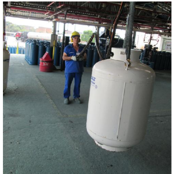
Figura 6 – Processo de movimentação com a talha.
