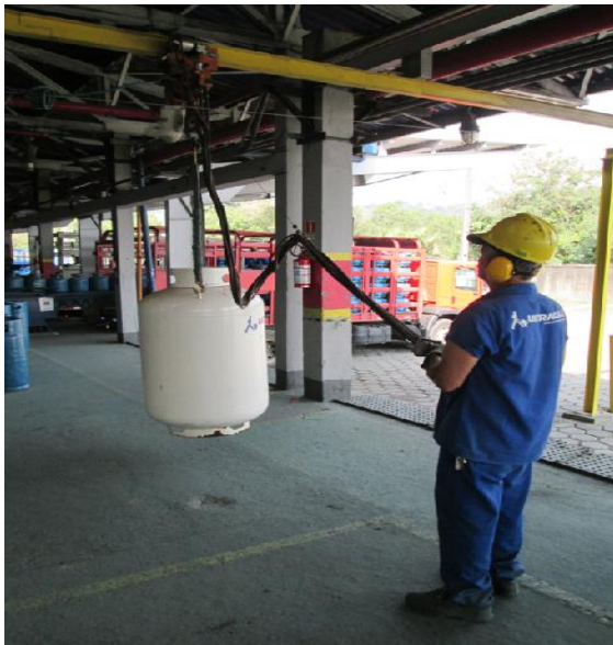
Figura 5 – Processo de movimentação com a talha.
