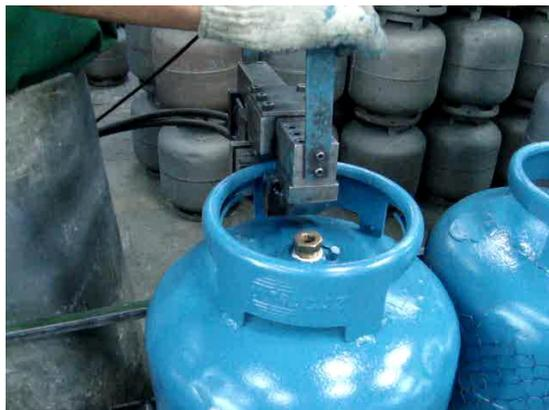
Figura 7 – Equipamento realizando furos no aro do recipiente
