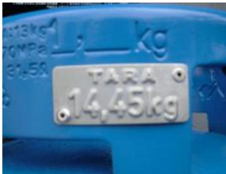
Figura 6: Plaqueta de tara posicionada e rebitada no aro superior de recipiente
