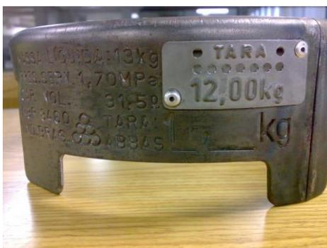
Figura 3 - Plaqueta com “furos”, uma alternativa para futura leitura automatizada.
