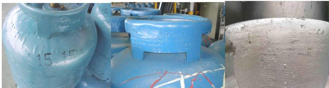
Figura 1: Exemplos de recipientes P-13 com tara impressa no corpo, gravação no aro superior ou gravação ilegível
