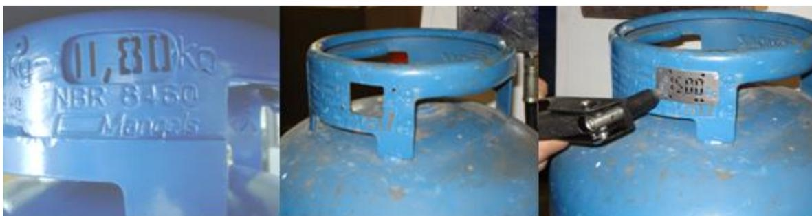
Figura 2 – Plaquetas com a numeração vazada e com necessidade de abrir uma “janela” na alça do recipiente
