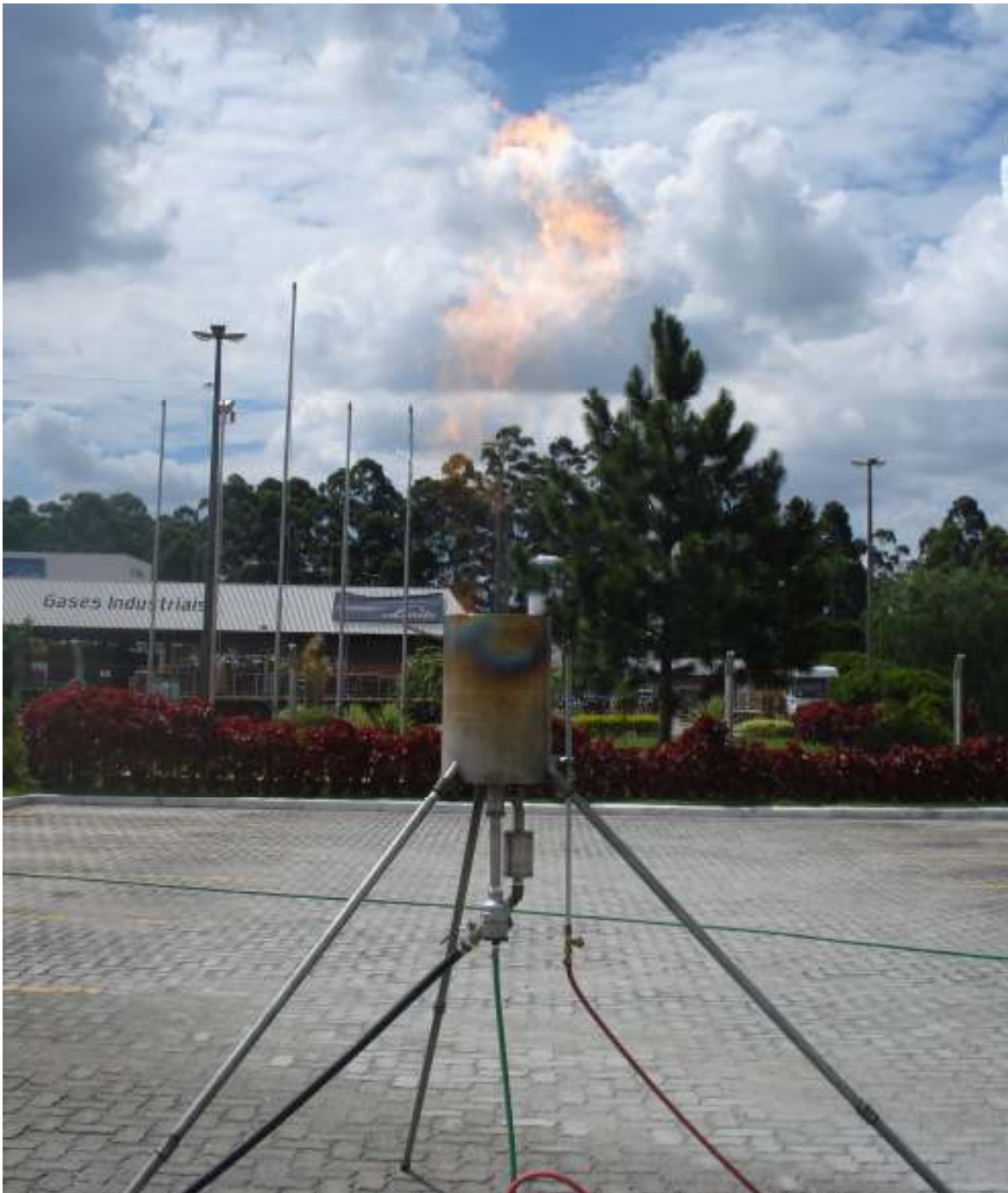
FIGURA 4. Flare definitivo queimando mistura nitrogênio-propileno.
