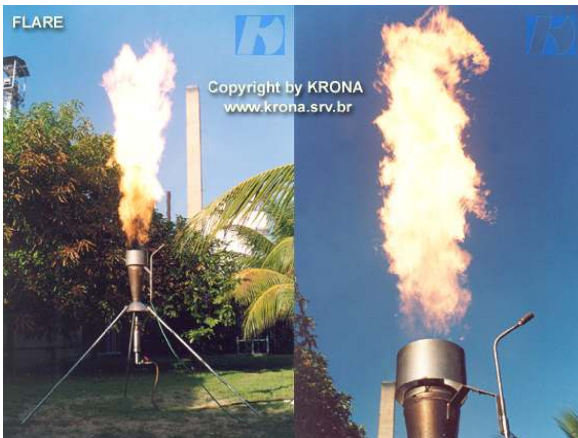
FIGURA 1. Teste do protótipo de flare com propileno.
