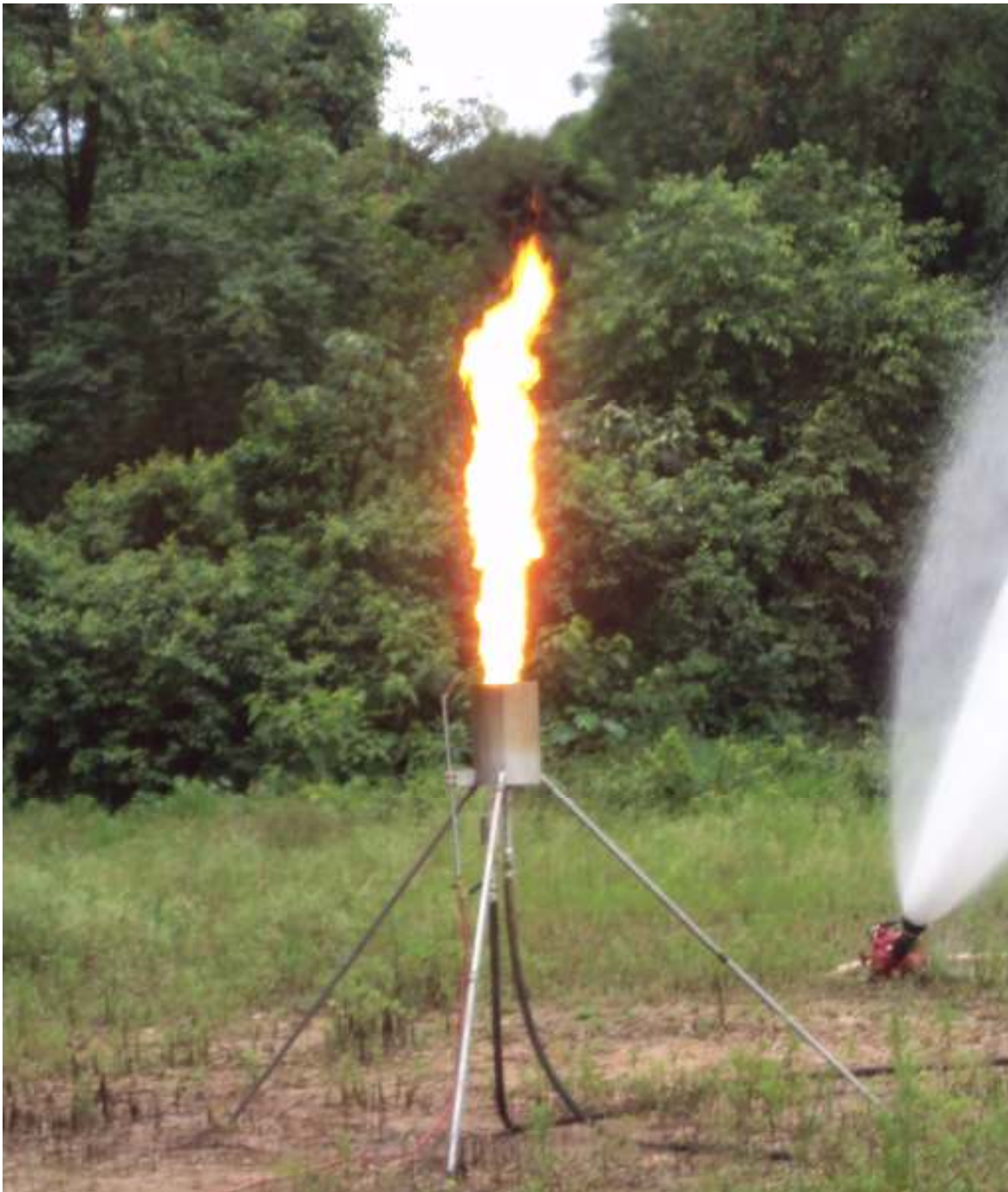
FIGURA 2. Teste do flare definitivo com butadieno.
