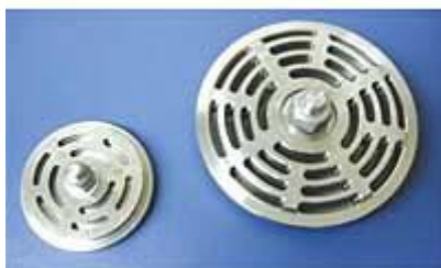
Fig. 3 – Válvulas de sucção/descarga
