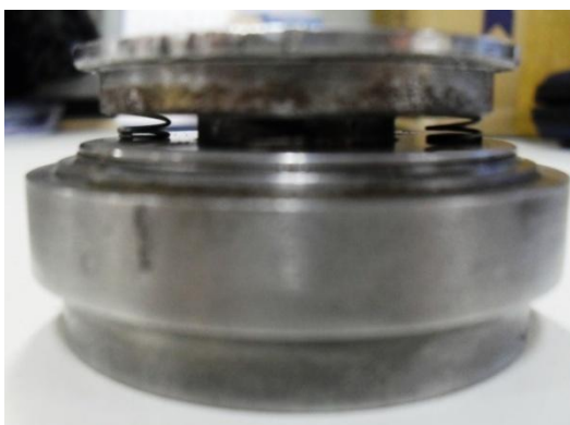
Fig. 7 – Molas das válvulas modificadas
