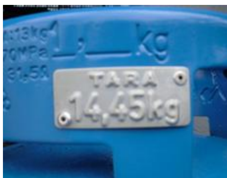
Fig. 2 – Aro superior com furo para colocação de plaqueta.
