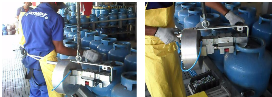
Fig. 5 – Equipamento realizando furos no aro do recipiente
