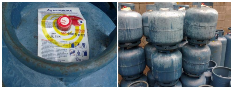
Fig. 1 – Recipientes com pintura danificada.
