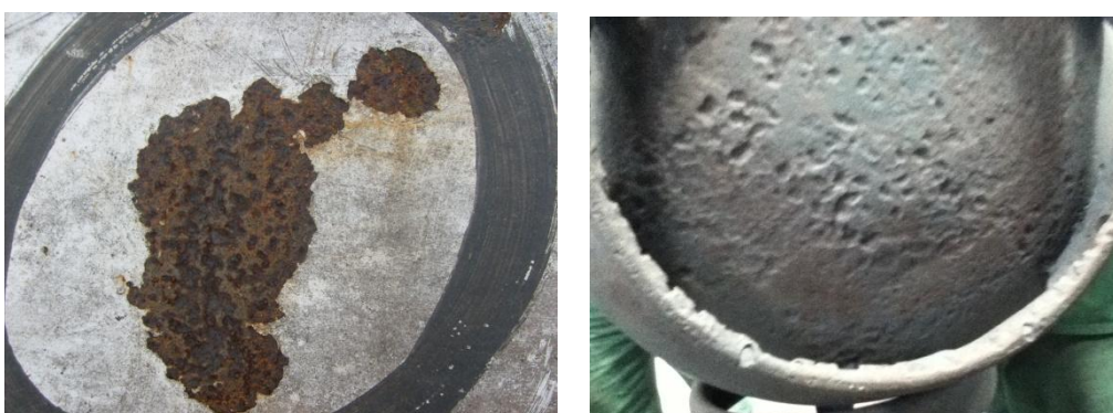
Fig. 3 – Recipientes com corrosão.
