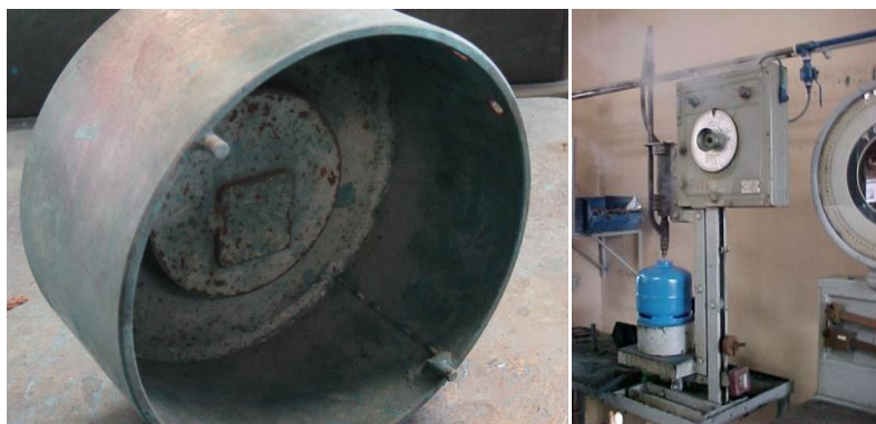
Figura 2: Calço para P-2 em (esquerda) e P-2 em equipamento de envasamento estacionário.
