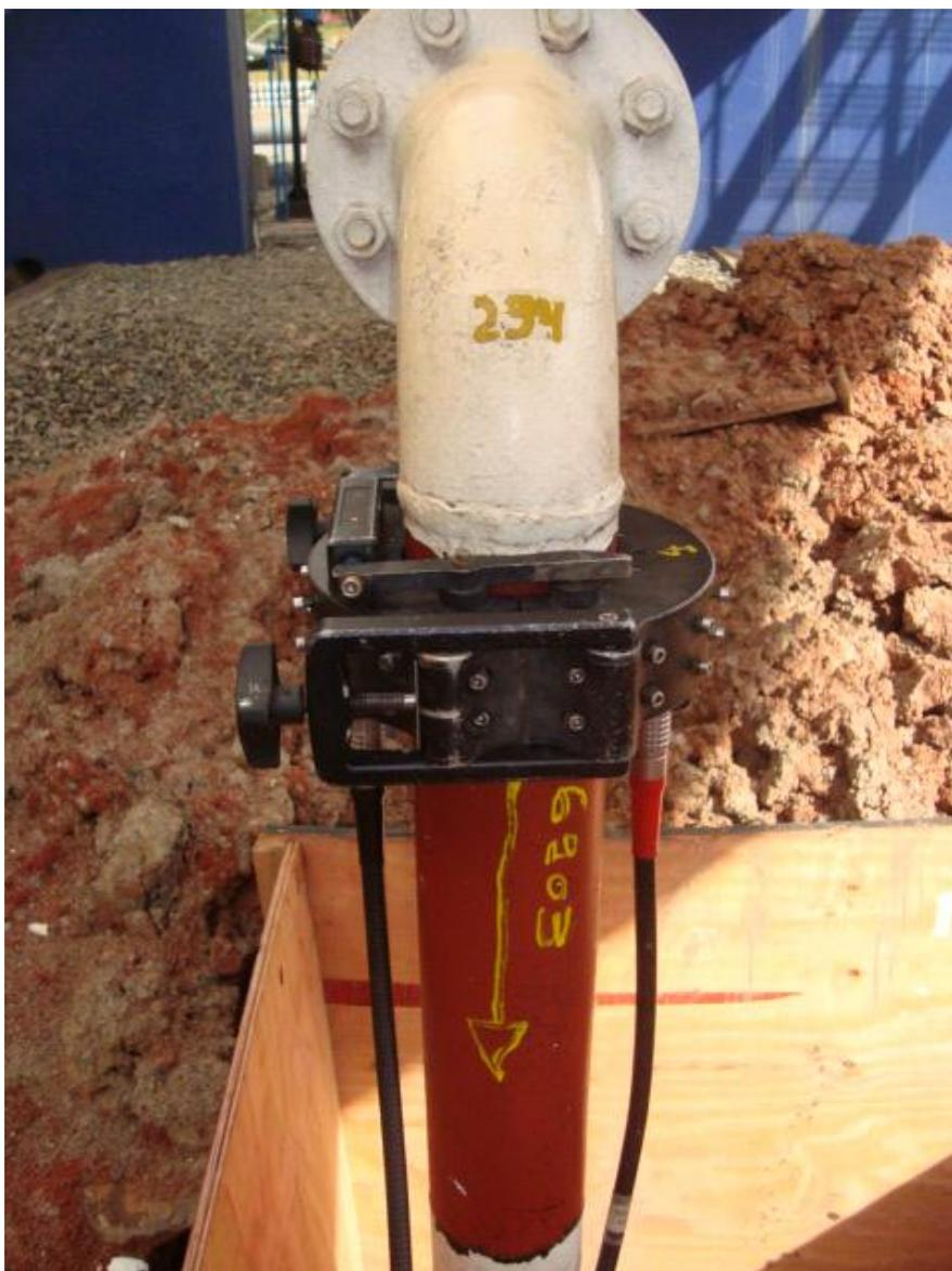
Figura 6 – Anel para tubulação de 4”
