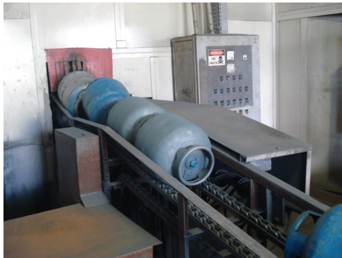
Fig. Fotos tiradas a cada ciclo de jateamento dos cilindros na requalificação
