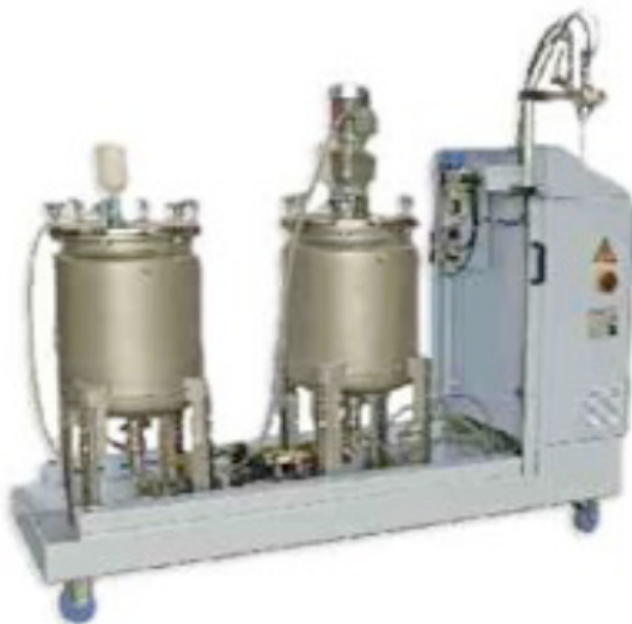
Fig. Foto de Estação de trabalho ADH 500/2201 para aplicação de adesivo Transpofix em fabricas de cilindros novos e empresas especializadas na aplicação de transponders aos cilindros existentes.
