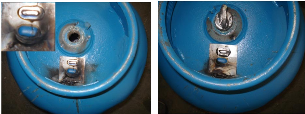
Fig. Capa metálica com ID 103M e capa plástica ID 103G coladas ao botijão
