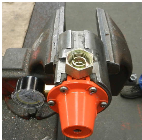
Figuras 2 e 3 – Montagem do regulador e do dispositivo de segurança nas conexões de ferro fundido maleável
