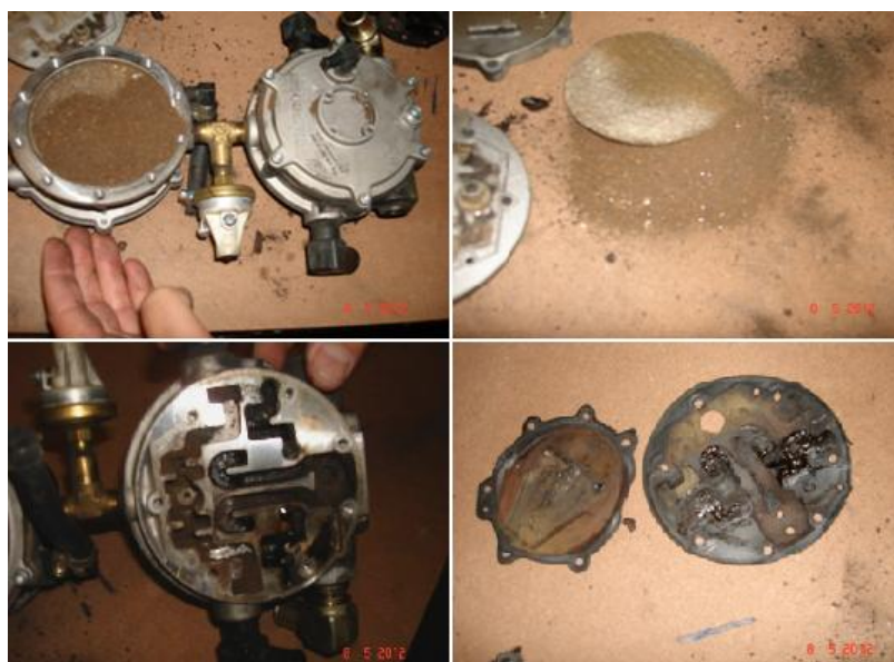
Figura 2 – Fotos mostrando a quantidade de sujeira acumulada no filtro, danificando assim a empilhadeira.
