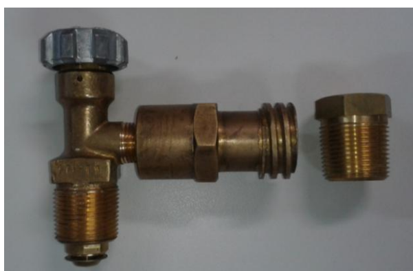
Figura 7 – Foto de uma válvula com engate à esquerda e uma válvula de segurança à direita, ambas utilizadas no vasilhame P-20. A válvula com filtro magnético substituiria as duas válvulas.
