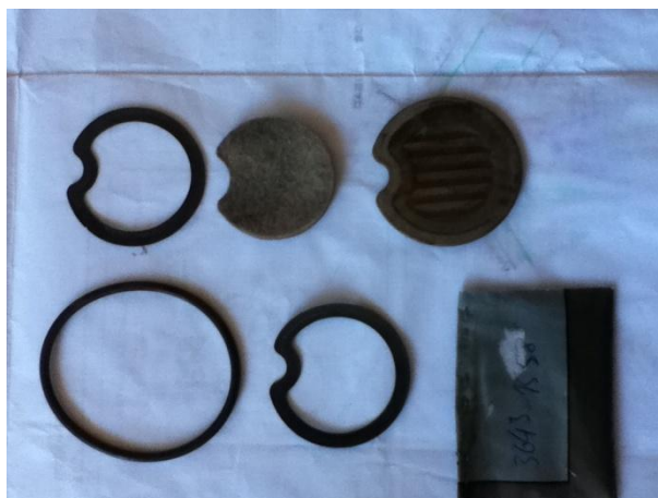
Figura 3 – Fotos mostrando componentes danificados pertencentes ao sistema de filtro no processo de queima de combustível. Pode-se observar a quantidade de resíduos presentes.
