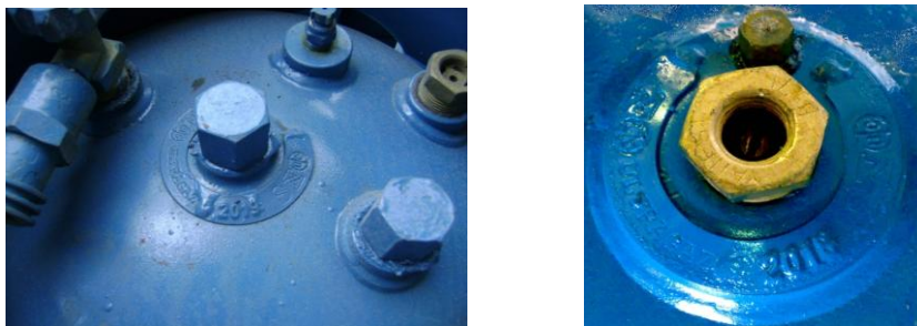
Figura 2: Exemplos de plaqueta ferradura de requalificação com data da próxima requalificação
