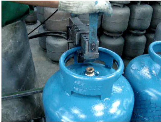
Figura 5 – Equipamento realizando furos no aro do recipiente
