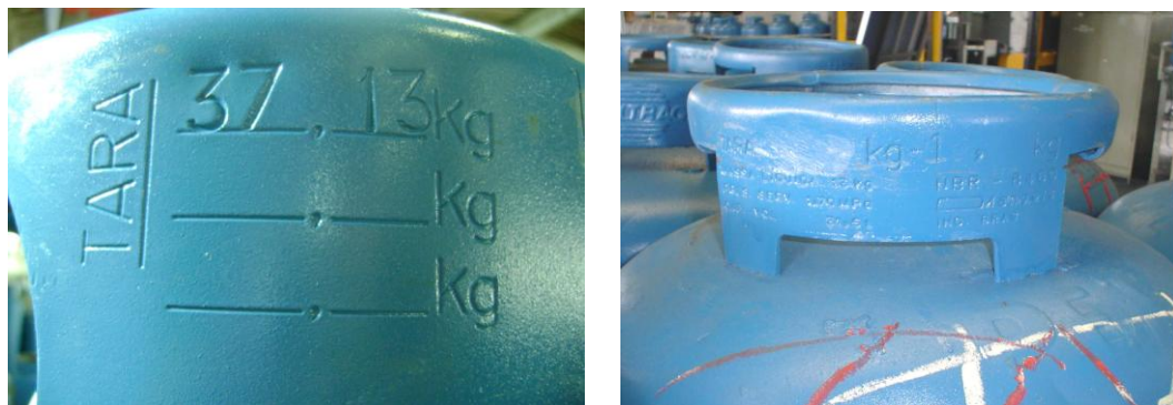
Figura 1: Exemplos de recipientes P-20 e P45 com tara impressa no corpo, gravação no aro superior ou gravação ilegível.
