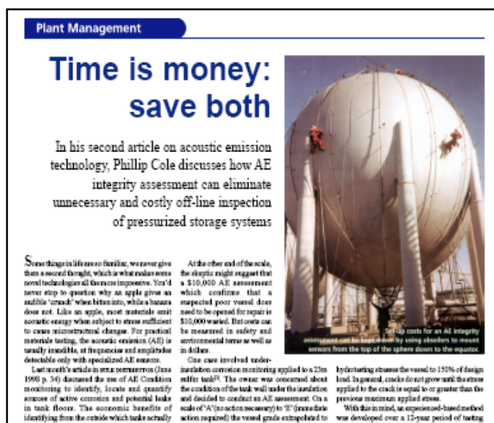
Figura 1 – Artigo de revista inglesa apresentando os ganhos da utilização da EA como técnica para a rápida inspeção de esferas de armazenamento: colocação de sensores com alpinismo e a pressurização com o próprio fluido, com pressão de 5 a 10% acima da pressão operacional. .
