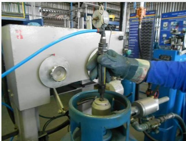
Foto 05: Posicionamento da caneta pneumática em contato com a válvula sendo pressionado pelo operador
