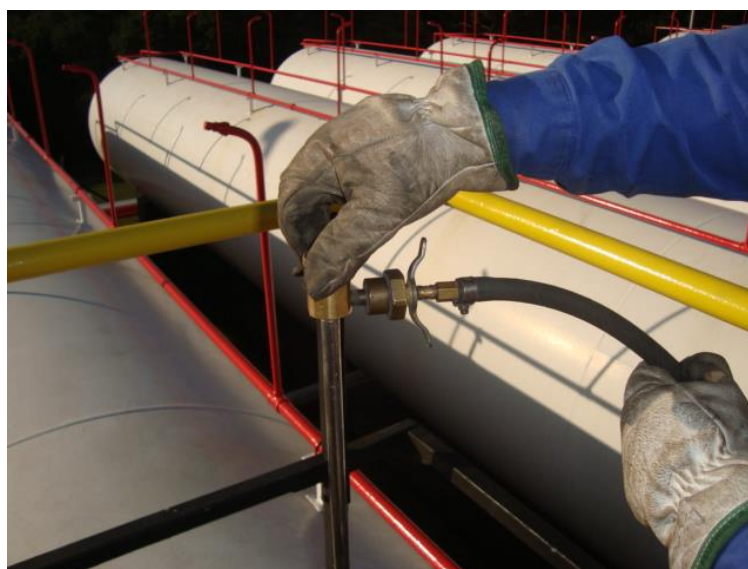
Foto 7: Conexão do Termodensímetro à VCA
