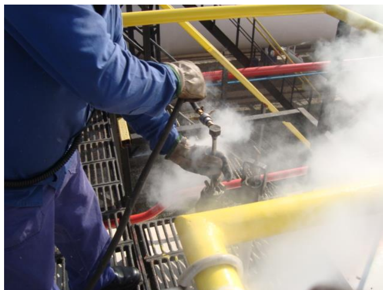
Foto 3 – Acoplagem da mangueira do termodensímetro à VCM
