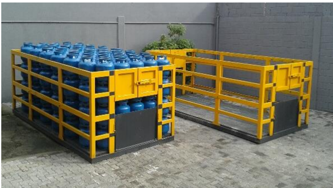
Foto 6 - Gaiolas, também chamadas de caixas para sistema poliguindaste para recipientes de GLP.
