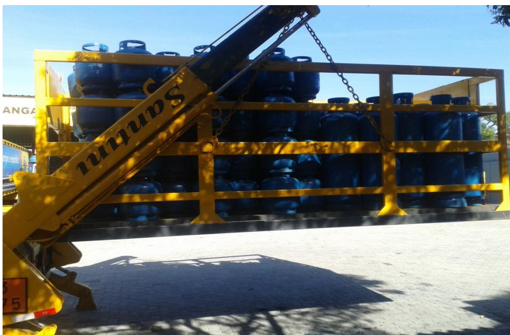
Foto 5 - Sistema de descarga em revendedor com veículo tipo poliguindaste para 260 recipientes tipo P13.
