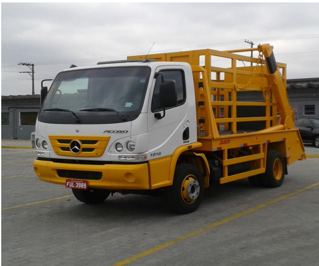
Foto 7 - Veículo vazio com sistema tipo poliguindaste para transporte de 160 recipientes de GLP tipo P13 por viagem.
