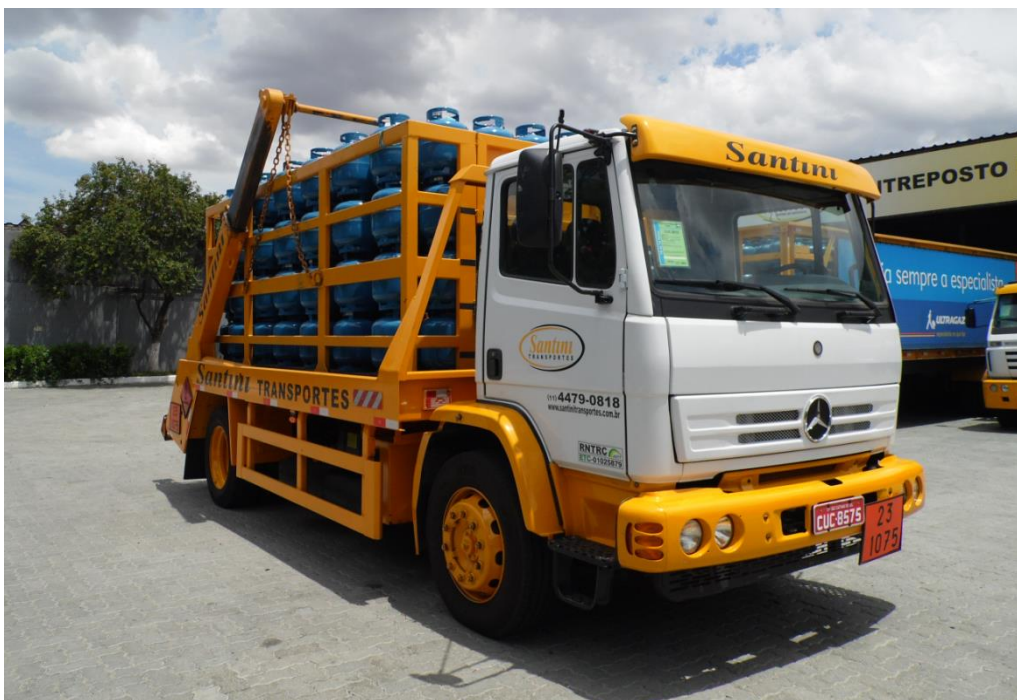
Foto 4 - Veículo com sistema tipo poliguindaste para transporte de 260 recipientes de GLP tipo P13 por viagem.
