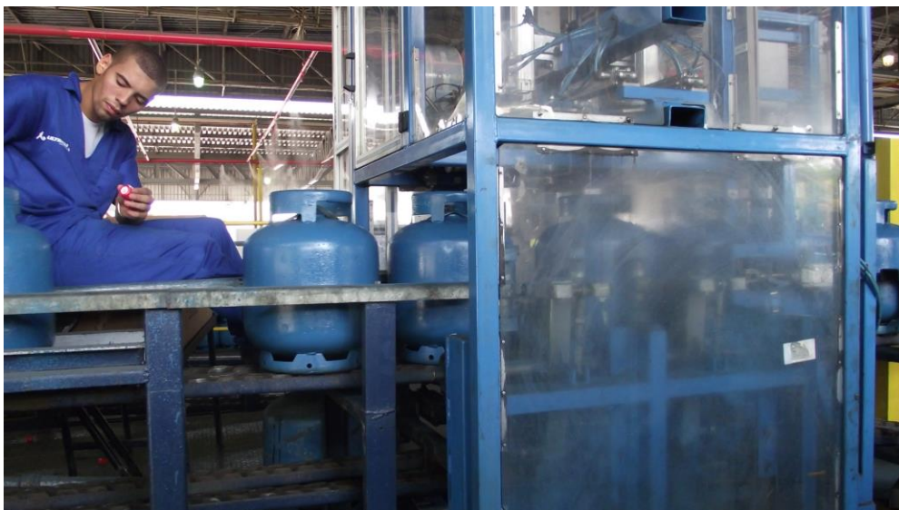
Figura 1 – Processo de colocação de Lacre e Etiqueta
