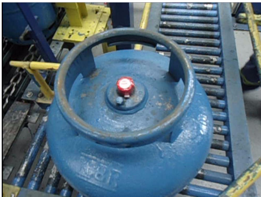
Figura 5 – Recipiente expulso por falta de Etiqueta
