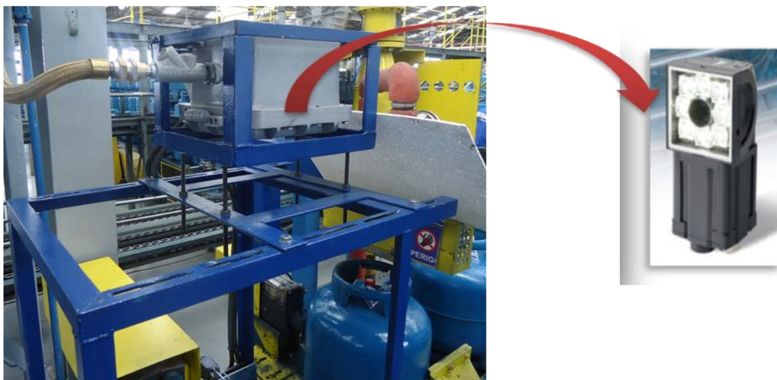
Figura 2 – Sensor de Detecção de Lacre e Etiqueta
