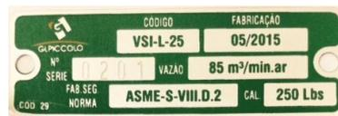
Figura 4 – Placa de identificação do coletor da válvula multi-point e da válvula de segurança
