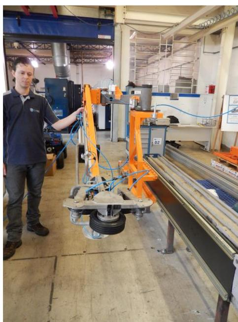
O equipamento encontra-se em fase de teste no fornecedor. Ajustes no sistema de avanço/ recuo, estão sendo finalizado o painel pneumático e sistema de freios que são necessários para testes reais na base de produção.
