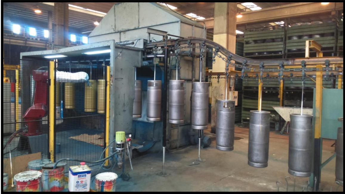
Figura 13 – Processo de Pintura Robotizado
