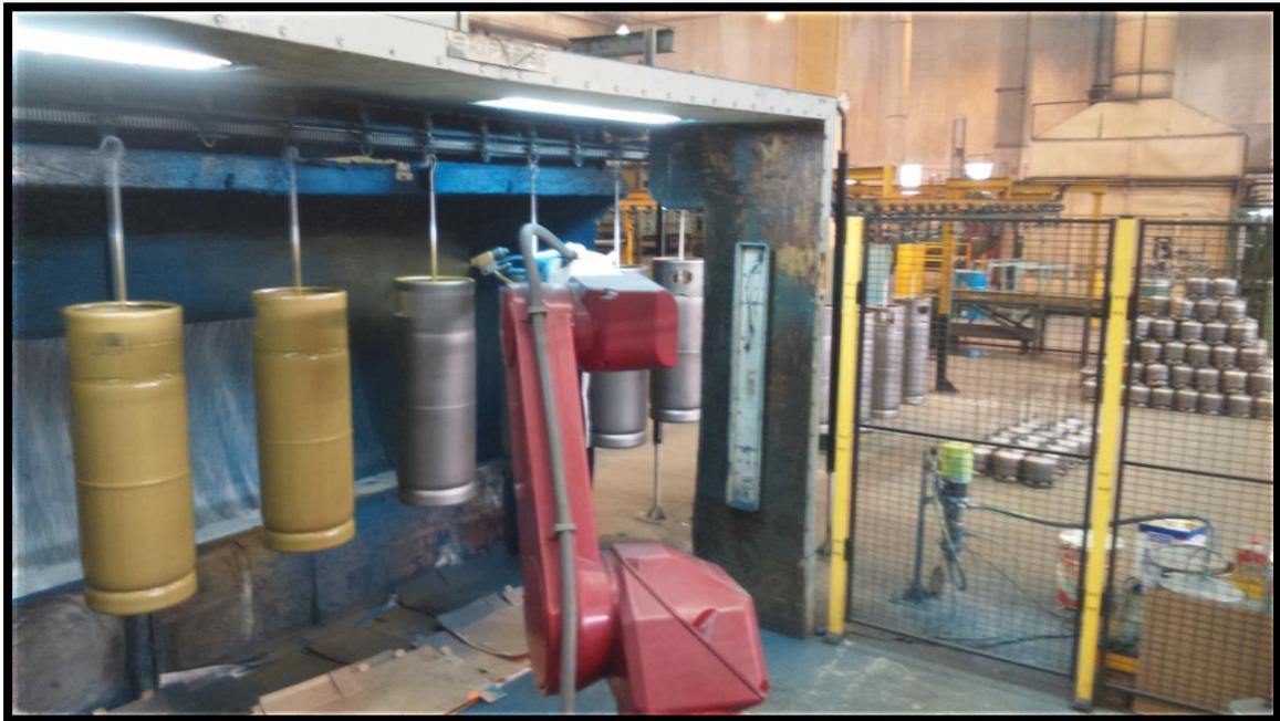
Figura 14 – Processo de Pintura Robotizado
