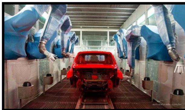
Figura 6 – Processo de pintura automatico
