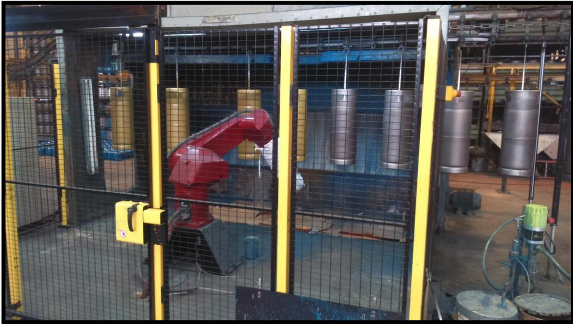
Figura 15 – Processo de Pintura Robotizado
