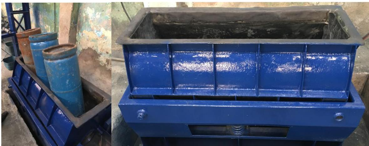
Cada família de recipientes permanece no equipamento por 60 segundos, a sujeira interna se volta e é direcionada a um coletor.
