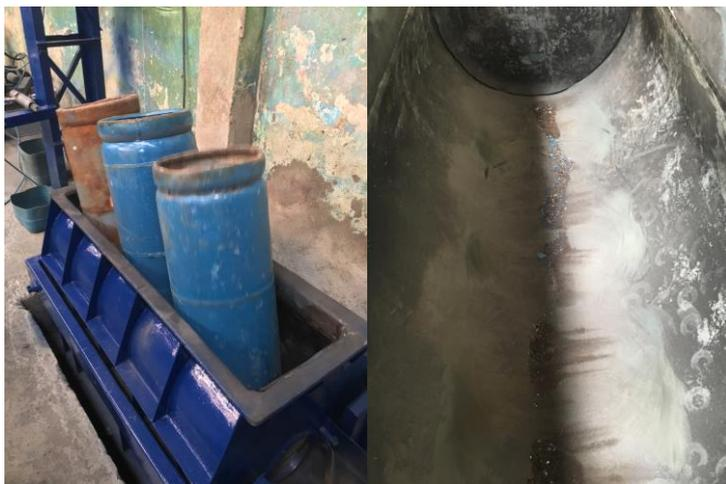
Depois o grupo A e B passaram pela primeira etapa de requalificação a lavagem interna, os cilindros molhados tiveram sua massa anotada e controlada e após dois dias de secagem a ao livre uma nova medição vou aferida para comparação ao peso inicial.
