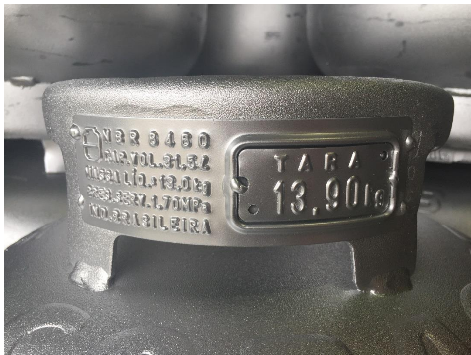
Figura 12: Fixação da Placa Repositora no colarinho por solda Mig
