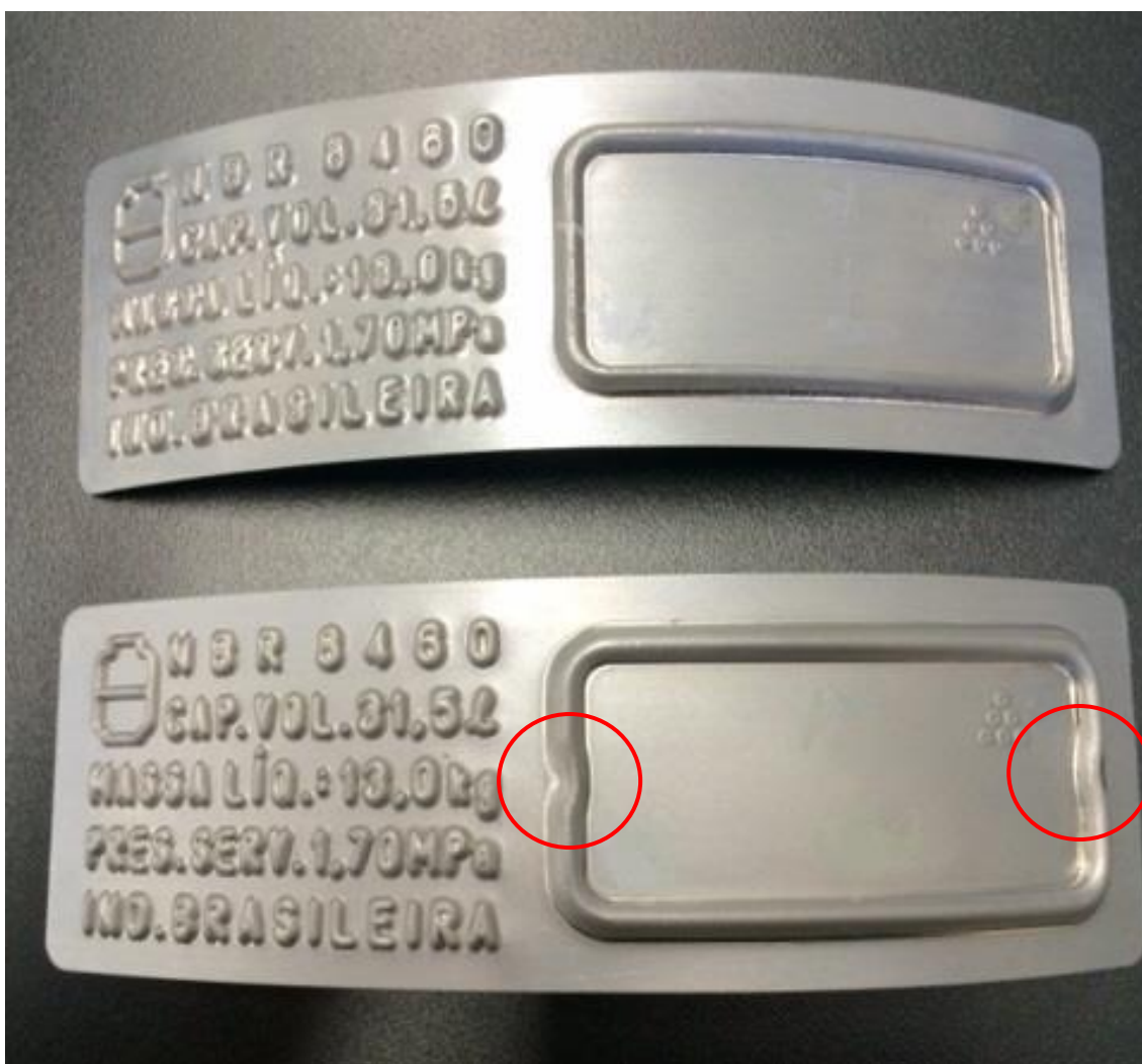
Figura 9: Modelos estudados de moldura em alto-relevo, visando destaque e proteção da Plaqueta de Tara e posição de soldagem, no detalhe da moldura
