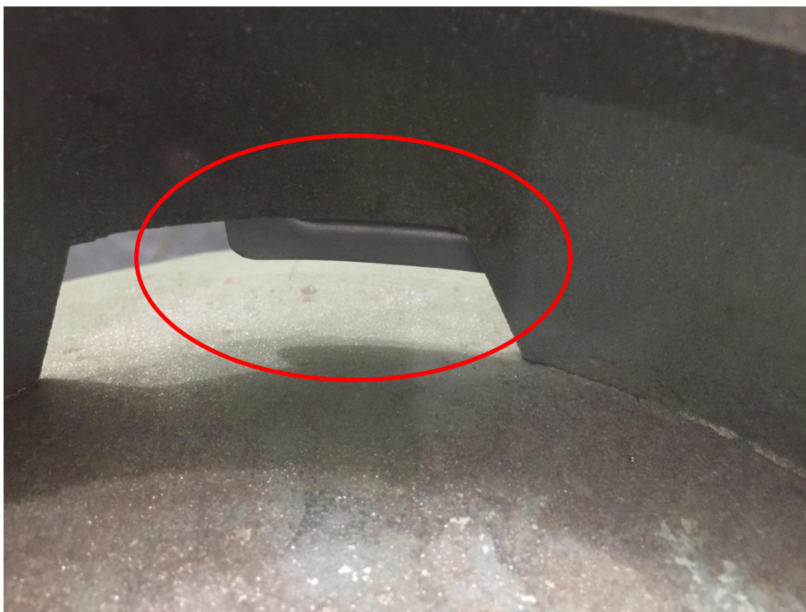
Figura 4: Exemplo de Placa Repositora sobressalente à superfície do colarinho
