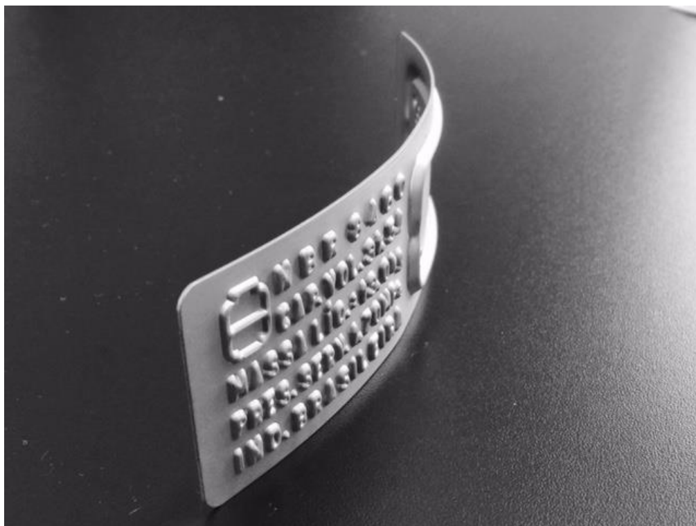
Figura 6: Curvatura da Placa Repositora de Informações
