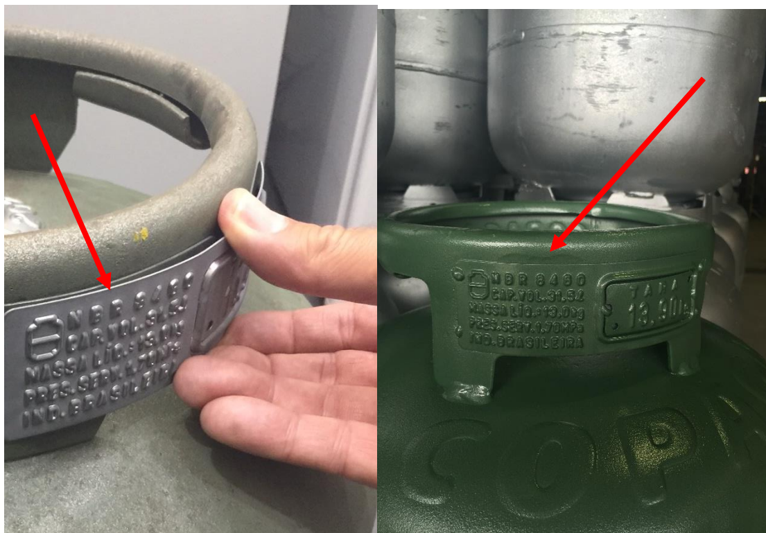
Figura 5: Demonstração da distância segura do início do repuxo superior do colarinho P-13 para aplicação da Placa Repositora de Informações, distância esta que visa evitar o cisalhamento da mesma no empilhamento dos recipientes
