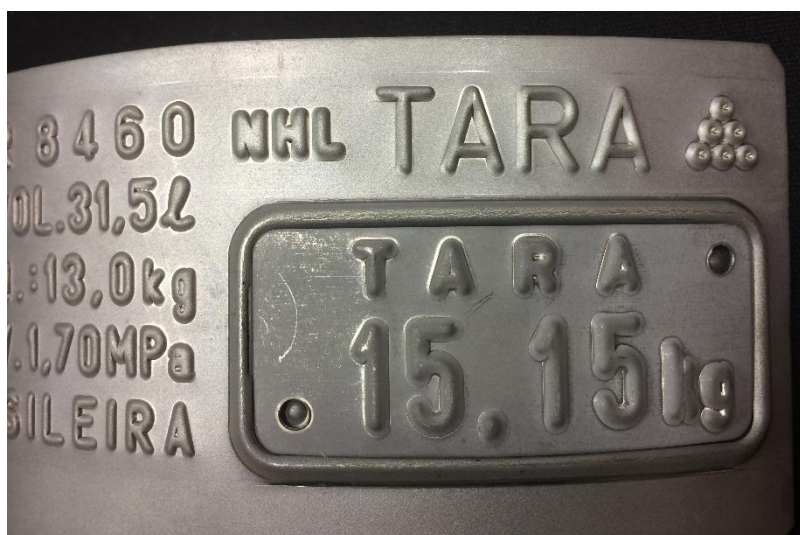
Figura 8: Plaqueta de Tara inserida em Placa Repositora com a palavra “TARA” estampada
