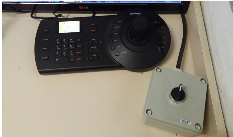
Figura 8 – Mesa controladora Speed Dome e comando do motor de movimentação das câmeras.
