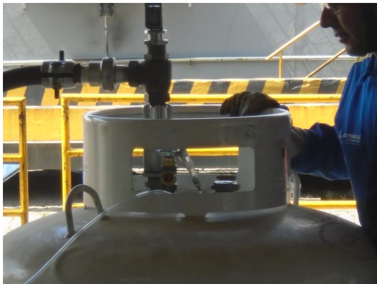
Foto 7 - Posicionamento da sonda nos recipientes para a captação da emissão do gás vaporizado.
