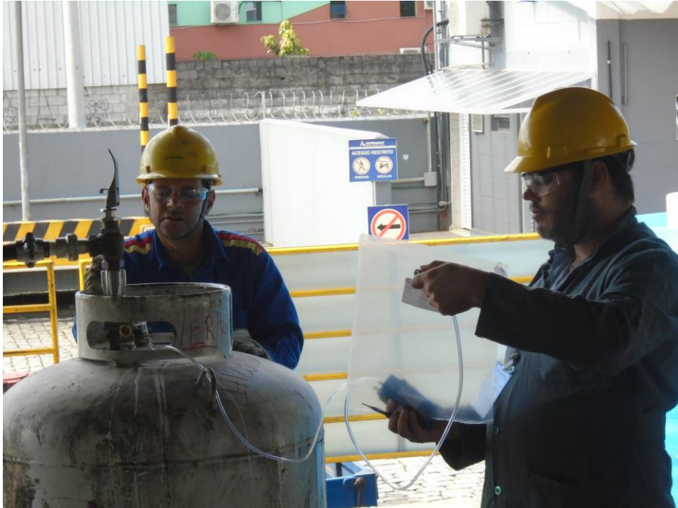
Foto 9 - Acoplamento do “balão” de coleta com a sonda de captação no recipiente com a nova válvula.
