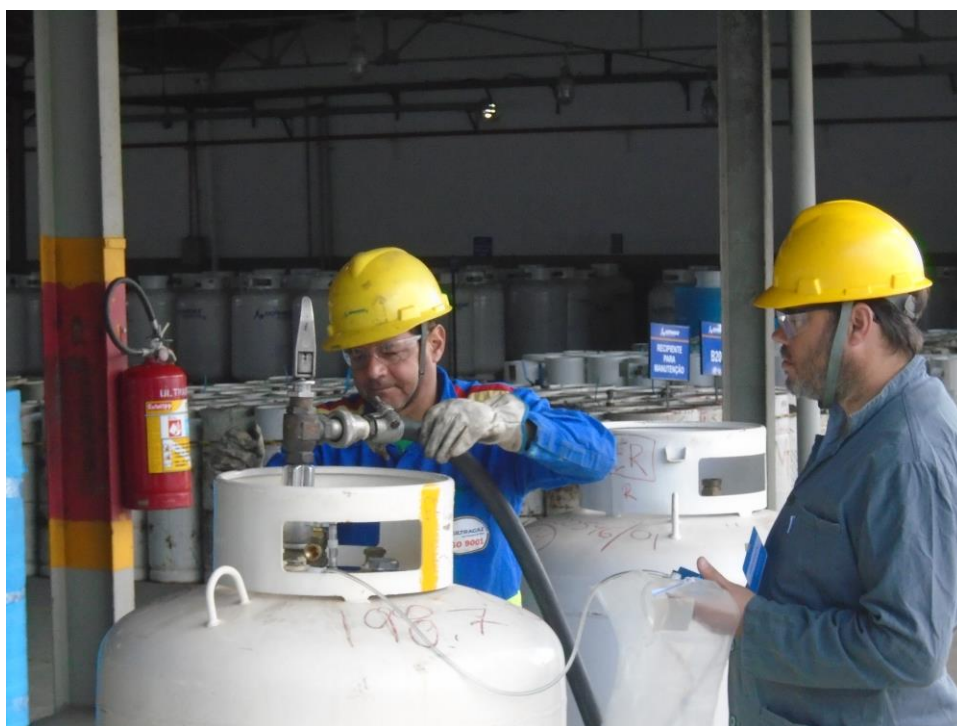
Foto 8 - Acoplamento do “balão” de coleta com a sonda de captação no recipiente com válvula convencional.
