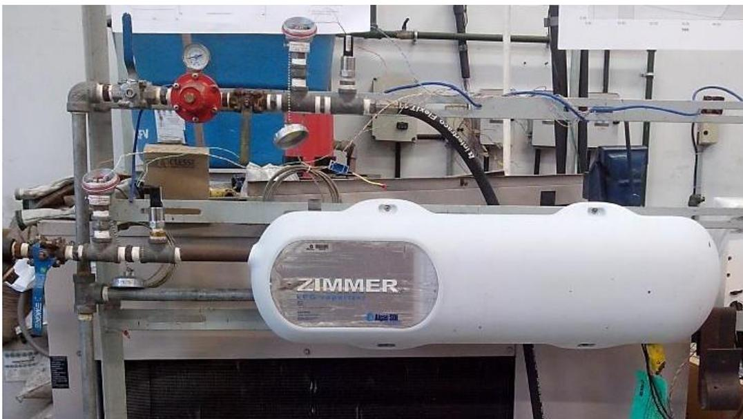
A câmara de combustão pode ser visualizada abaixo juntamente com o queimador instalado na mesma:
