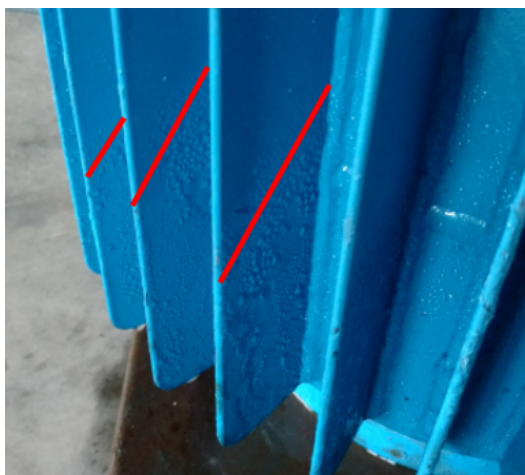
Figura 6 - Influência das aletas na troca de calor
