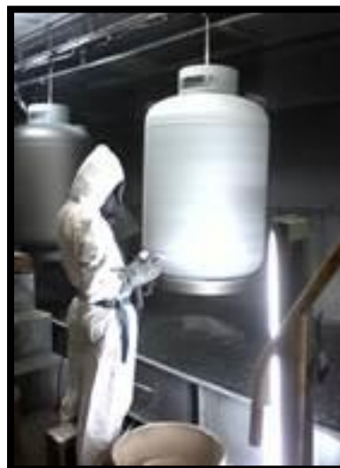
Figuras 5 e 6 – Processo de Metalização manual na Estamparia Industrial Aratell
