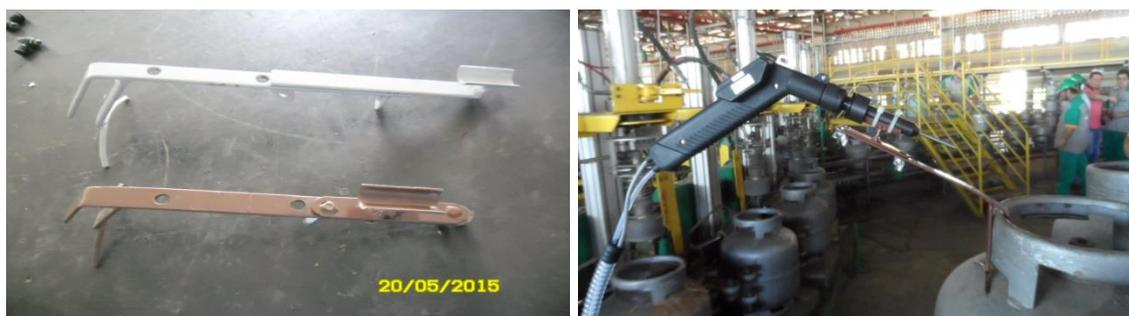
**Figura 12 - Suporte para a sonda do analisador TVA-1000B**
