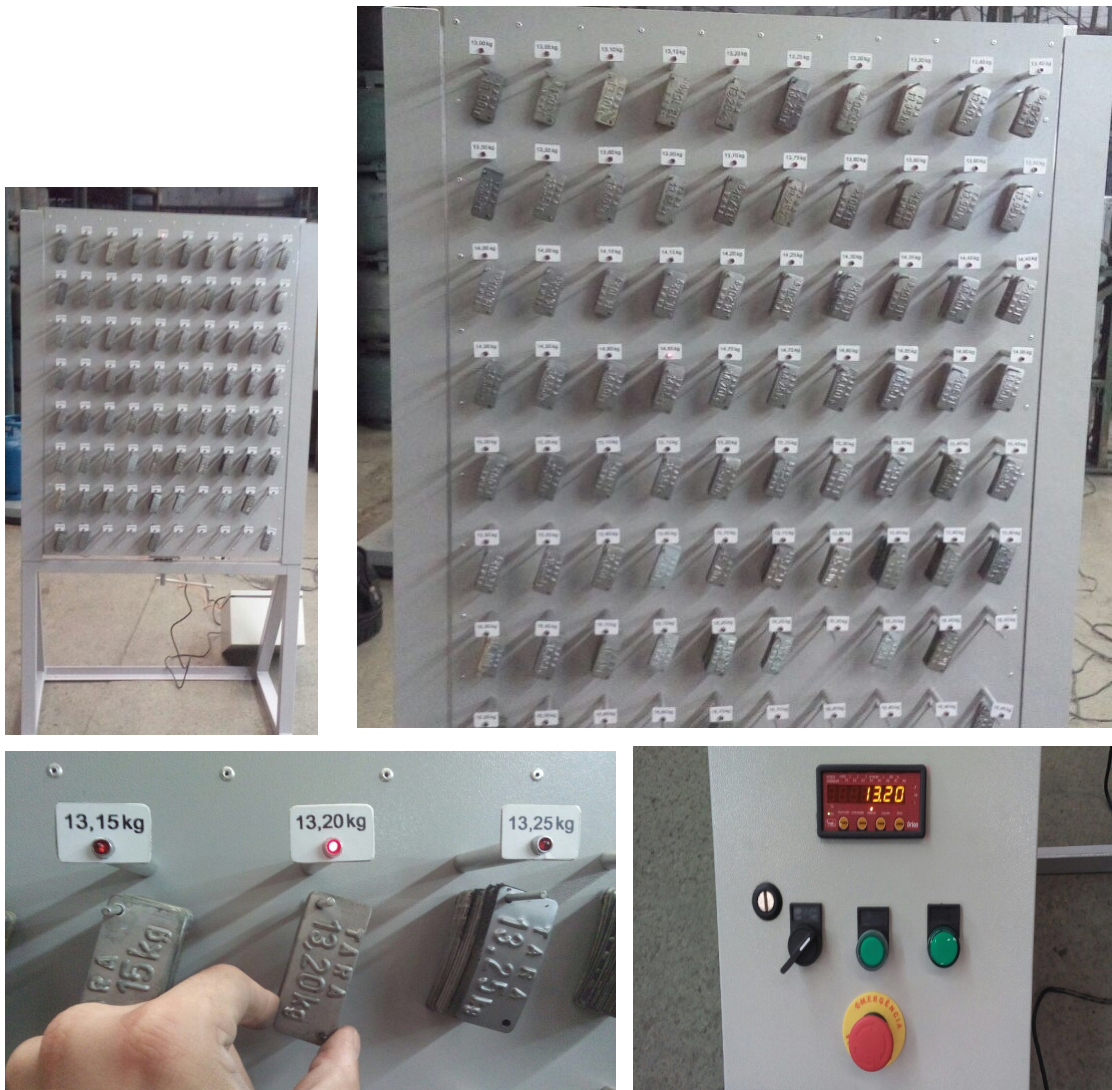
4.2-Teste painel para seleção de plaquetas de tara em processo produtivo de requalificação.
