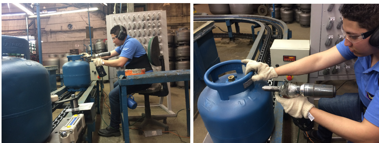
4.2-Teste painel para seleção de plaquetas de tara em processo produtivo de requalificação.
