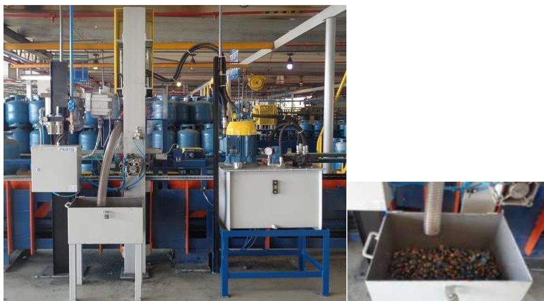
Imagem 05: Equipamento Automático de Retirada da válvula (fundo)
