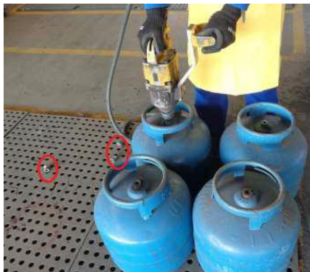
Imagem 03: válvulas espalhadas pelo piso
