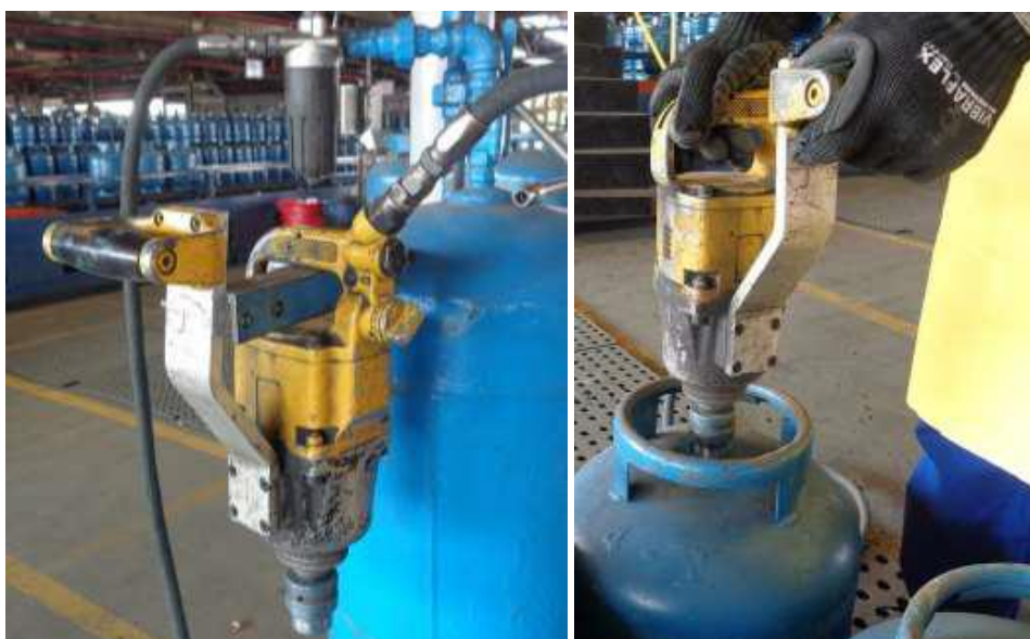
Imagem 02: Equipamento Manual para retirar válvulas
