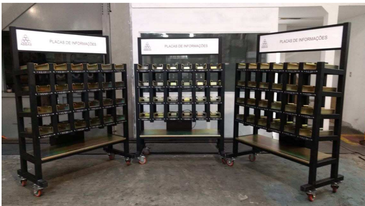
Figura 11- Estante Modular para Armazenagem e Seleção Automática de PIs (3 módulos)
