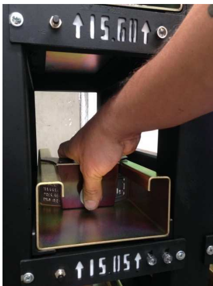
Figura 14- Espaço entre magazines dimensionado para o deslize da mão/ braço do operador para pega da PI através do Posicionador/ Assentador
