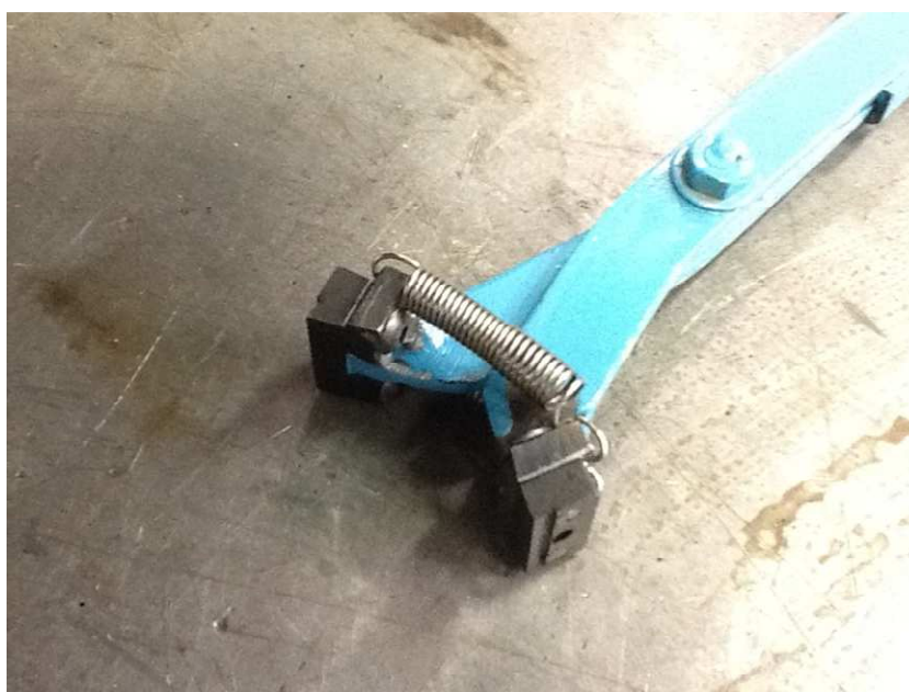
Figura 24- Ponteiros removíveis do Alicates para Abertura das Garras
