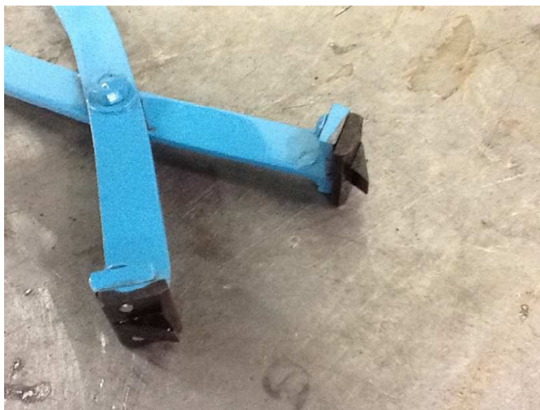
Figura 21- Ponteiros removíveis do Alicate para Retirada da Plaqueta de Tara da PI
