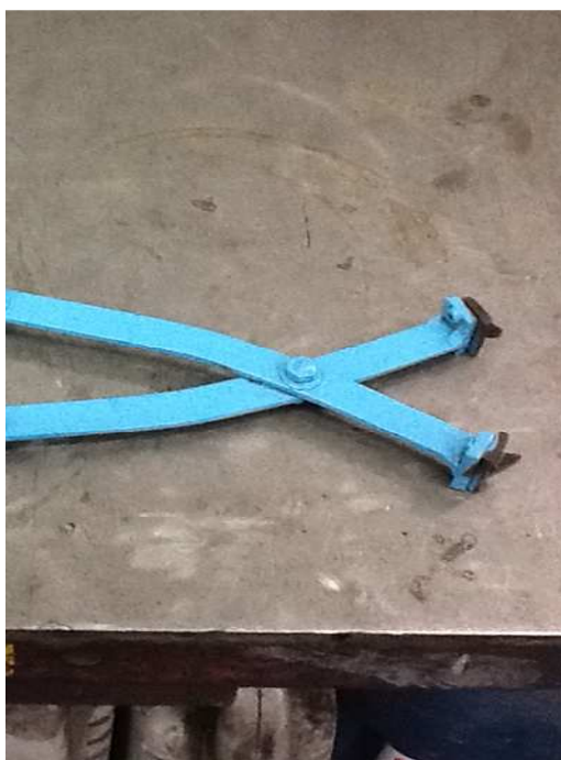
Figura 20- Alicate para Retirada da Plaqueta de Tara da PI
