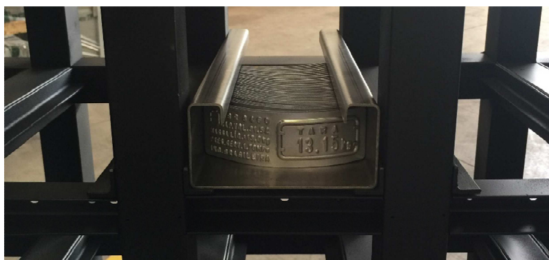
Figura 13 - Magazines com dobras especiais para receberem e permitirem o deslize do Posicionador/ Assentador
