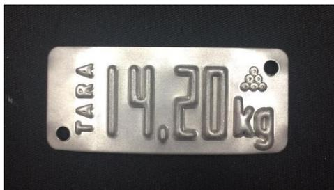
*Figura 4- Primeiro protótipo da Plaqueta de Tara de Alta Definição: nova fonte, deslocamento da palavra "TARA" para a lateral esquerda da peça e aumento do tamanho dos caracteres numéricos*
