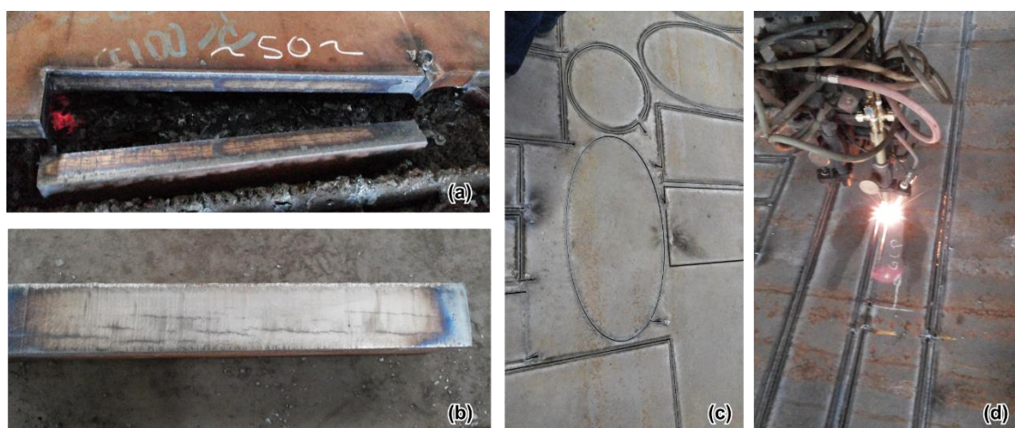
Figura 4 – Avaliação da qualidade do corte e desempenho. (a) Paralelismo do corte, (b) rugosidade, (c) formação de escória, (d) medição da velocidade de corte.
