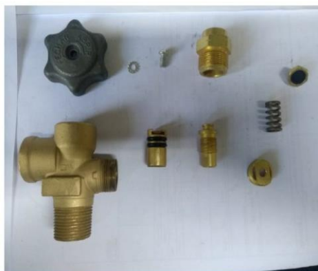
Imagem: Desmontagem registro P.45
