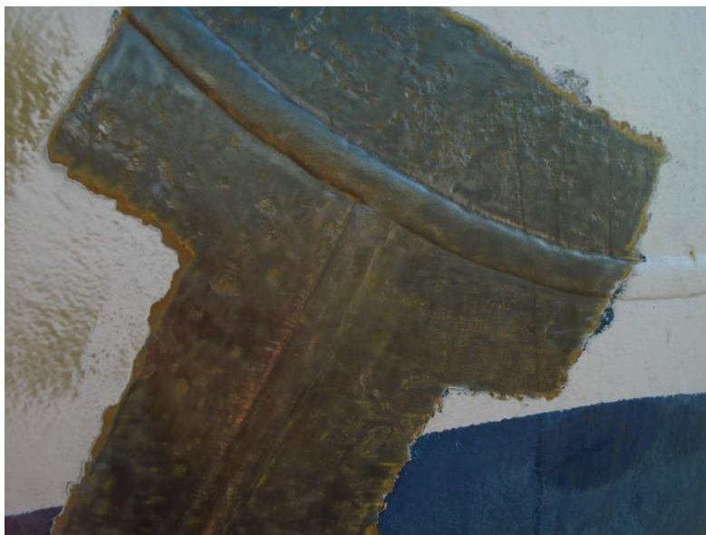
Figura 7 – Lixamento completo da área a ser analisada.
