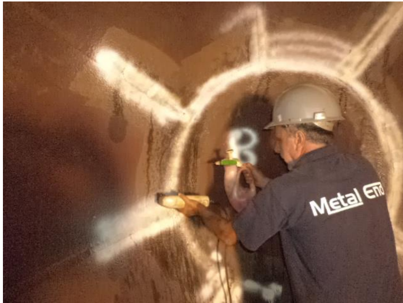
Figura 9 – Ensaio de partícula magnética no interior do vaso.
