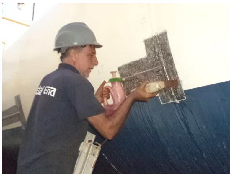
Figura 8 – Ensaio de partícula magnética.
