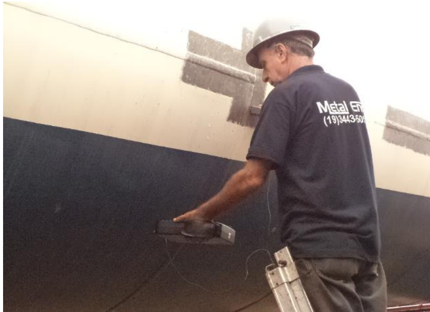
Figura 1 – Exemplo de execução de ensaio de ultrassom.
