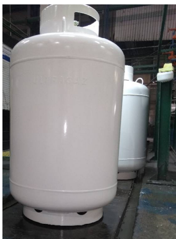
Figura 11- Cilindro após teste estanqueidade
