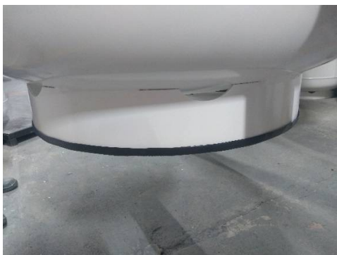
Figura 9- Proteção colocada após pintura
