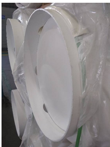
Figura 13- Argola inferior sem danos da pintura após retirada da proteção
