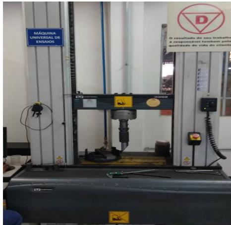
Figura 2 – Máquina universal para ensaios
