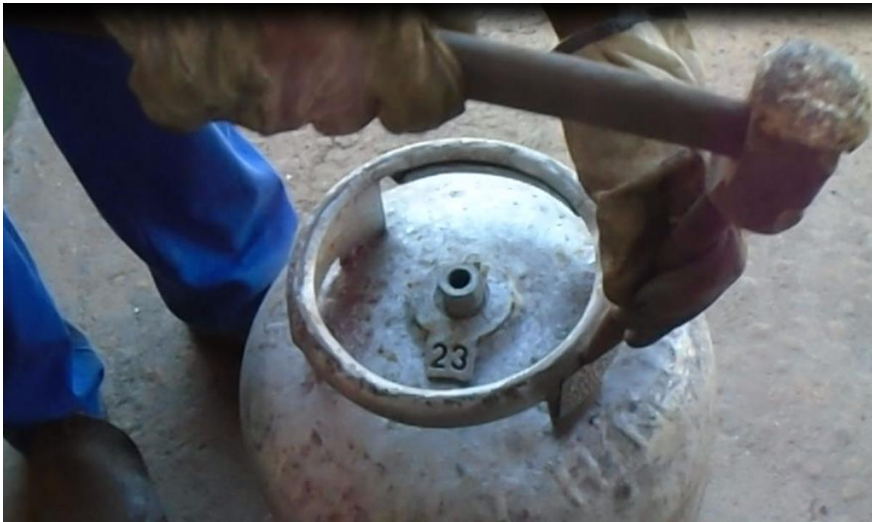
Figura 7 Operador realizando teste de retirada das plaquetas após período de cura do adesivo.
