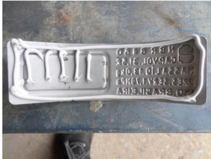
Figura 3 Aplicação em filete contornando toda extremidade da plaqueta + 4 filetes na região da plaqueta de tara (vasilhame P-13).
