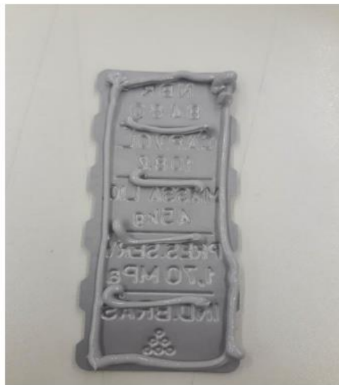
Figura 4 Aplicação em filete contornando a extremidade no meio com 4 filetes ao longo das seções das plaquetas (Cilindro P-20/P-45).
