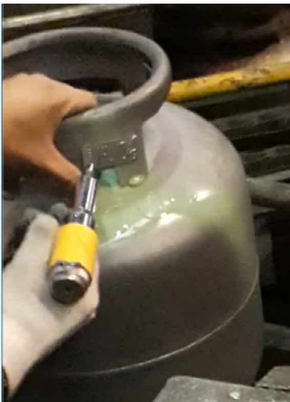
Figuras 6 e 7 – Fixação com Rebitadeira simples
