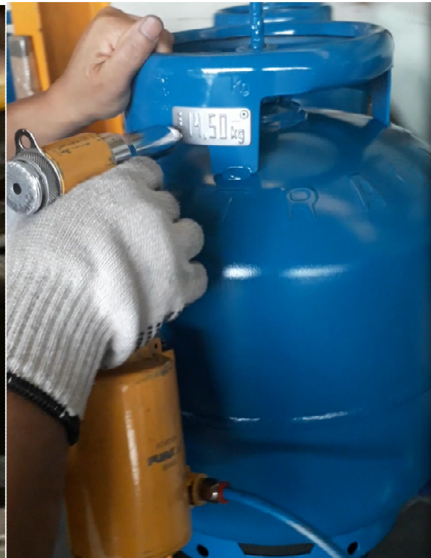
Figuras 6 e 7 – Fixação com Rebitadeira simples
