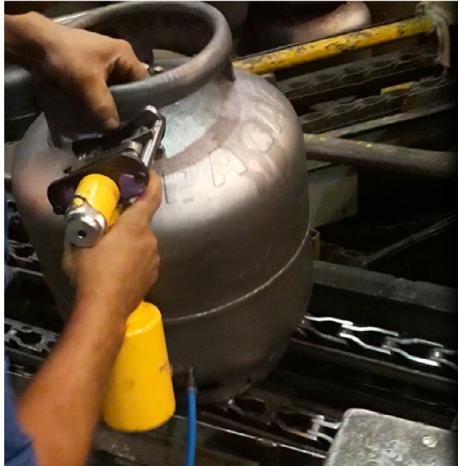
Figura 5 – Fixação com Rebitadeira dupla
