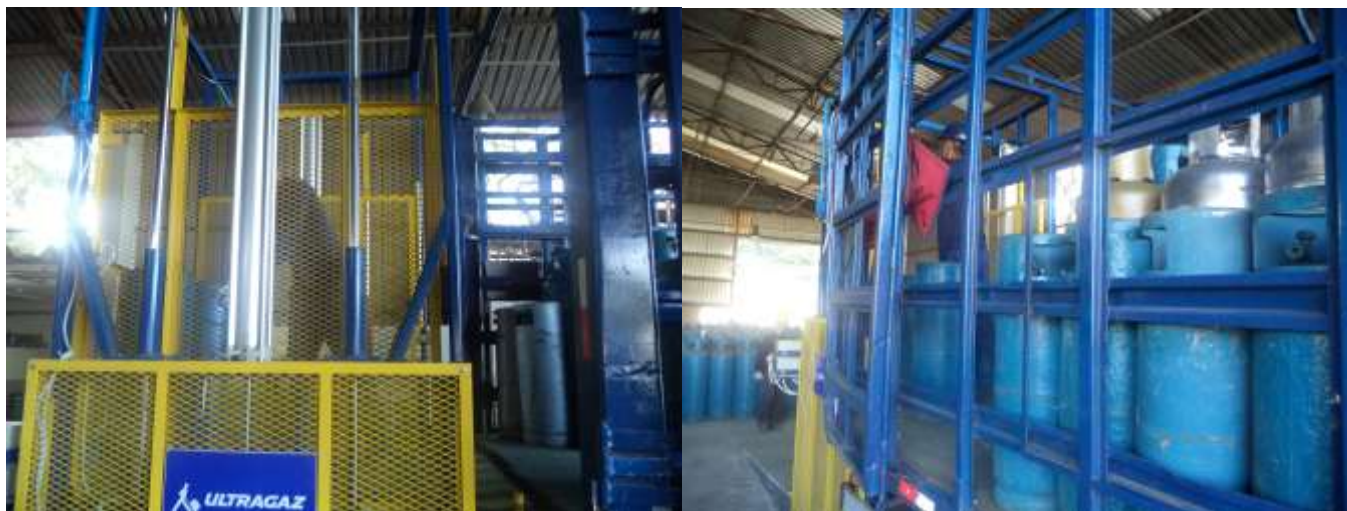
Figuras 19 e 20 – Processo de descarga após a implementação da plataforma;
