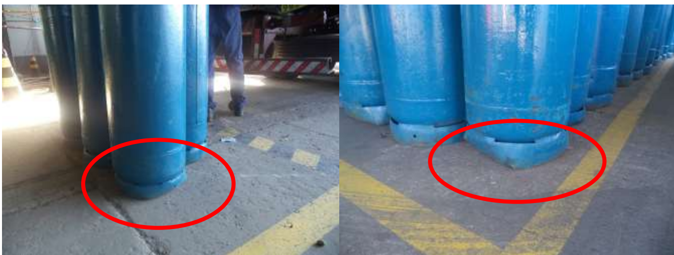
Figuras 5 e 6 – Vasilhames com aros inferiores danificados;
