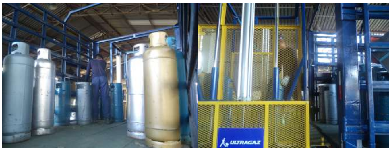
Figuras 17 e 18 – Processo de descarga após a implementação da plataforma;
