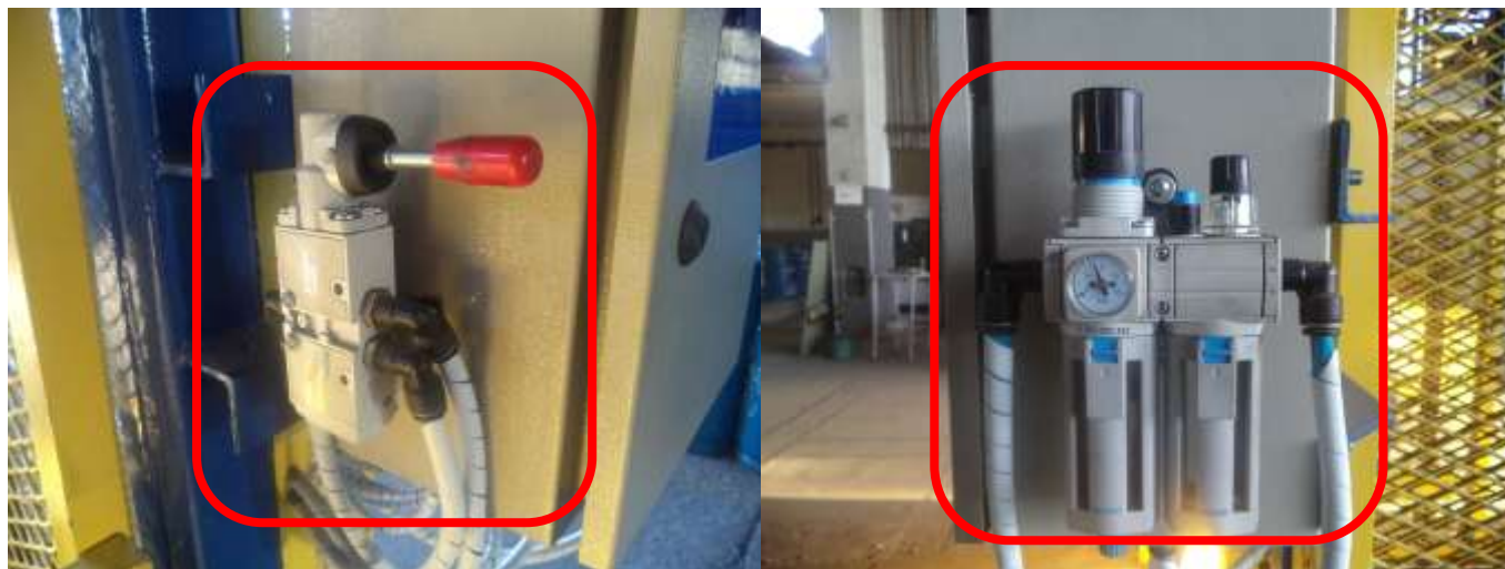
Figuras 13 e 14 – Circuito pneumático da PTA, com detalhes para o acionamento por válvula 5/3 vias de centro fechado na primeira imagem, e sistema RFL na segunda;
