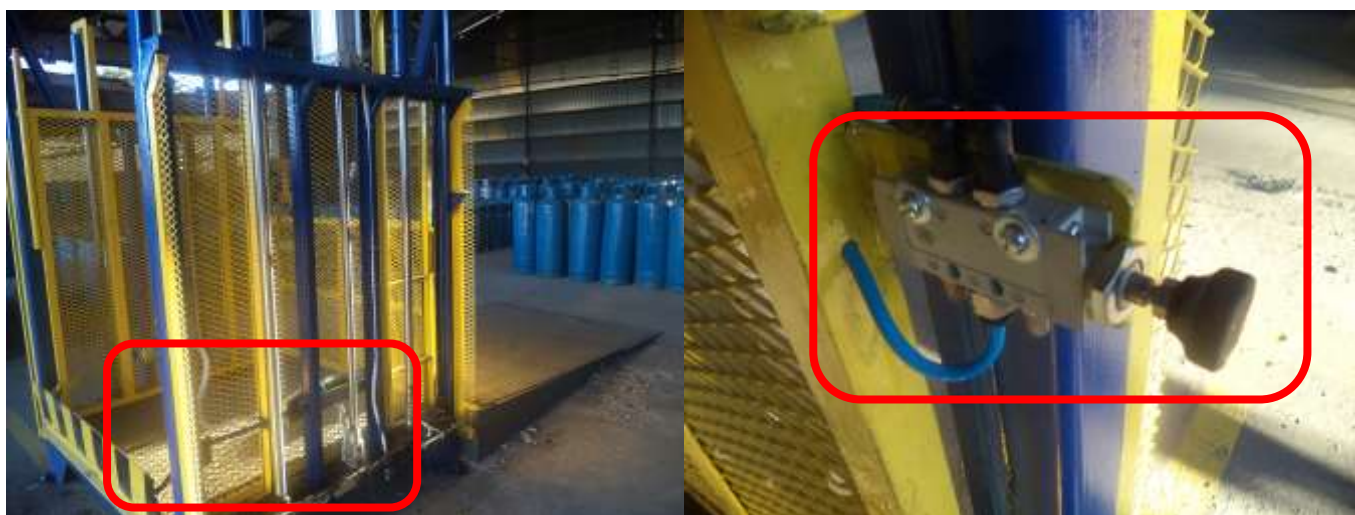
Figuras 13 e 14 – Circuito pneumático da PTA, com detalhes para o acionamento por válvula 5/3 vias de centro fechado na primeira imagem, e sistema RFL na segunda;
