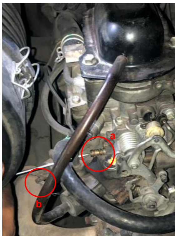
Figura 5 - Carburador e seu parafuso de ajuste de vazão da mistura ar/combustível em destaque; a) Parafuso de regulagem mistura ar/combustível; b) Parafuso de injeção de marcha lenta. Fonte: os autores, 2019
