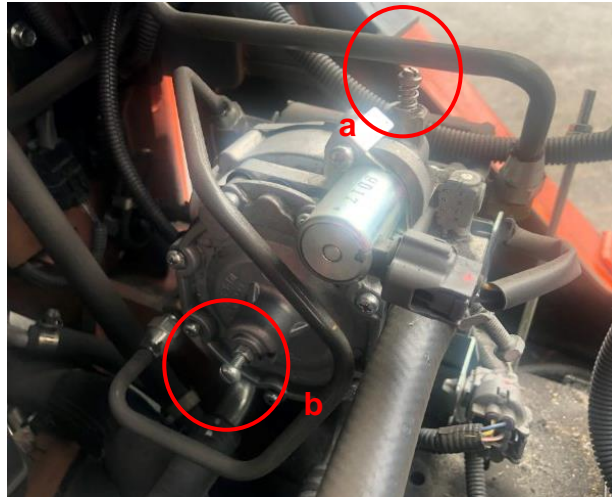
Figura 3 - Converter de uma empilhadeira Toyota; a) Parafuso de ajuste de vazão de marcha lenta; b) Parafuso de ajuste de pressão de saída de GLP. Fonte: os autores, 2019.
