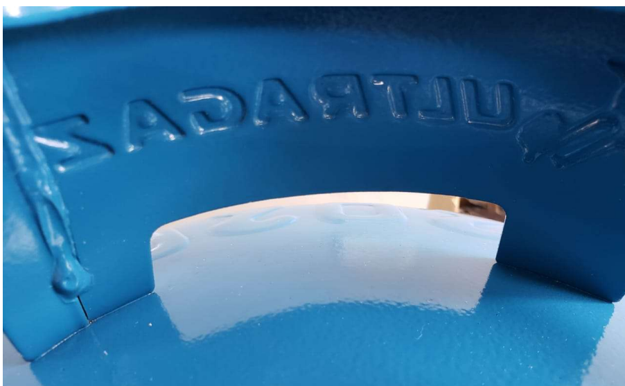
Recipiente sem primer anticorrosivo (Exposição por 30 horas)
