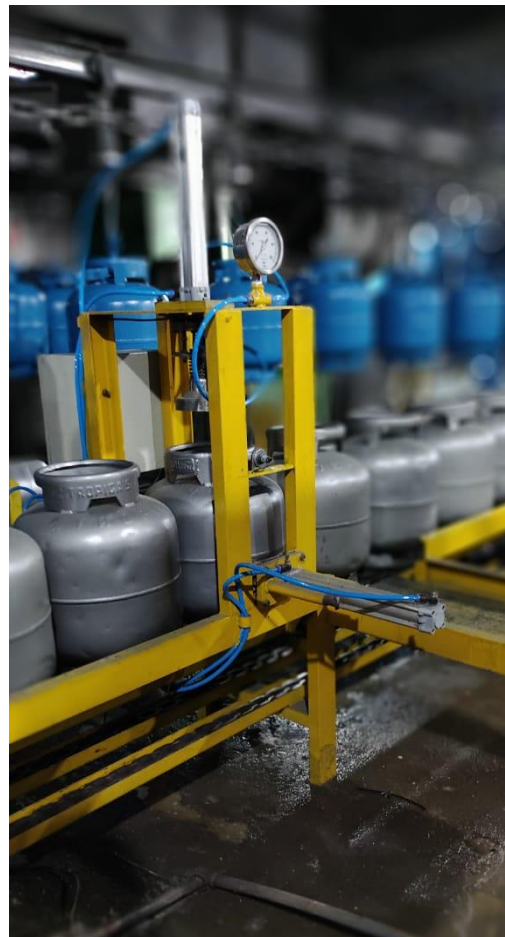
Figura 07 – Equipamento verificador da Pressão Interna de Recipientes
