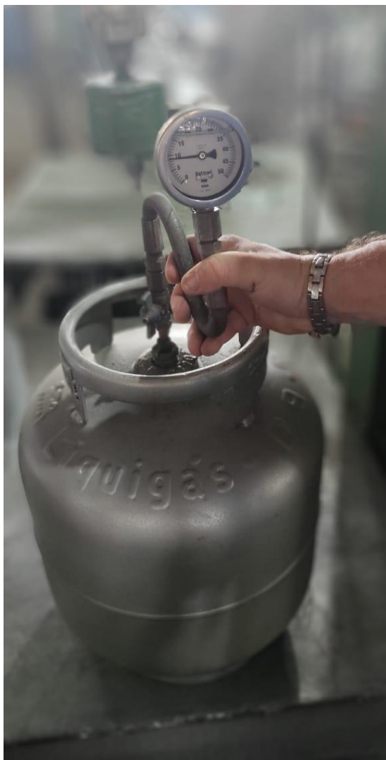
Figura 03 – Conjunto Cone Borboleta e Manômetro para verificação da pressão interna
