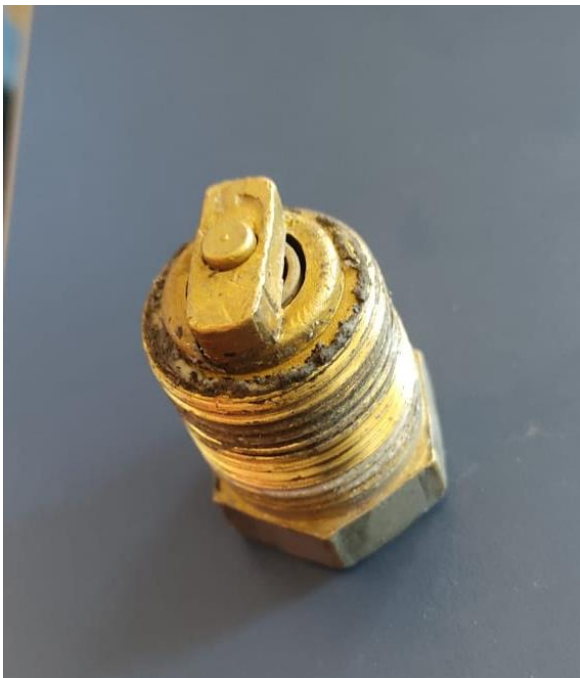
Figura 04 - Defeito na abertura da válvula recuperada, pino travado
