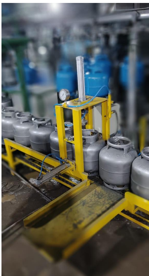
Figura 07 – Equipamento verificador da Pressão Interna de Recipientes
