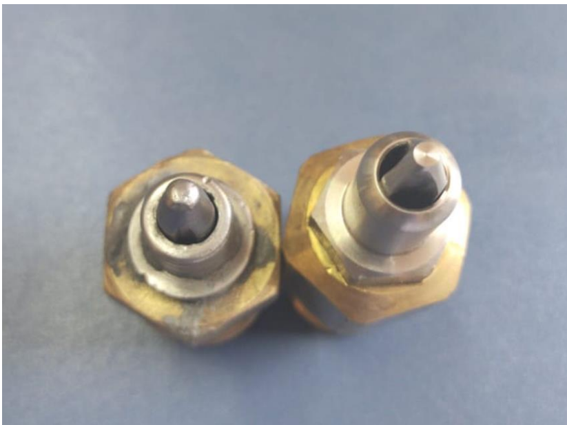
Figura 05 – Dois bicos enchimento, o da esquerda danificado
