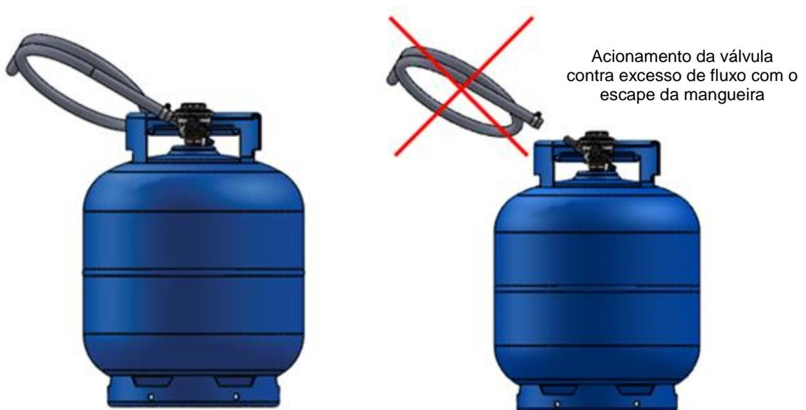
Figura 4 - Botijão P10 Com Regulador Clip On
