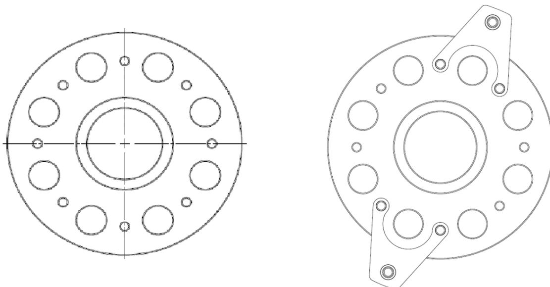
O medidor Levelgage sai de fábrica calibrado e montado na posição de furação de flange em “X” porém, caso a disposição da furação seja em “+” cruz
