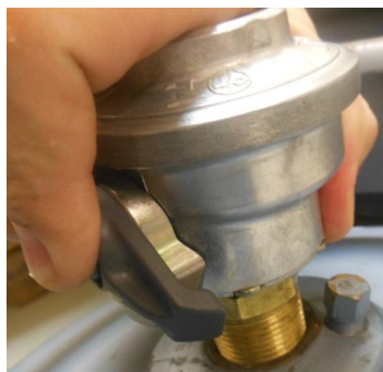
Figura 5 - Válvula sendo conectada no botijão
