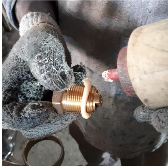
*Figura 4 - Aplicação de vedante na válvula através de bisnaga*
