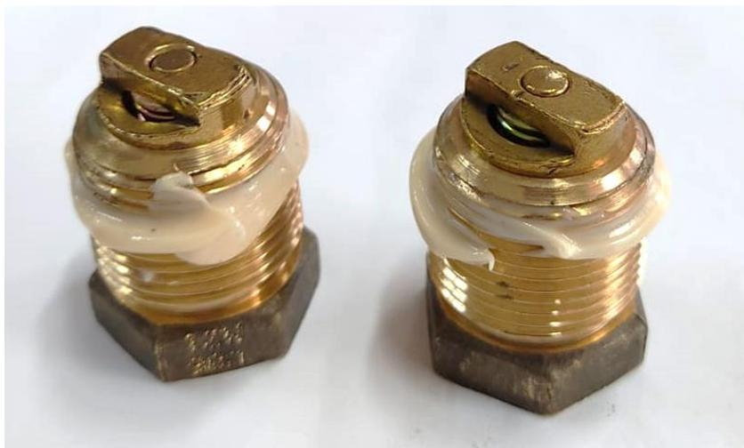
*Figura 5 - Resultado da aplicação de vedante utilizando bisnaga (método anterior)*
