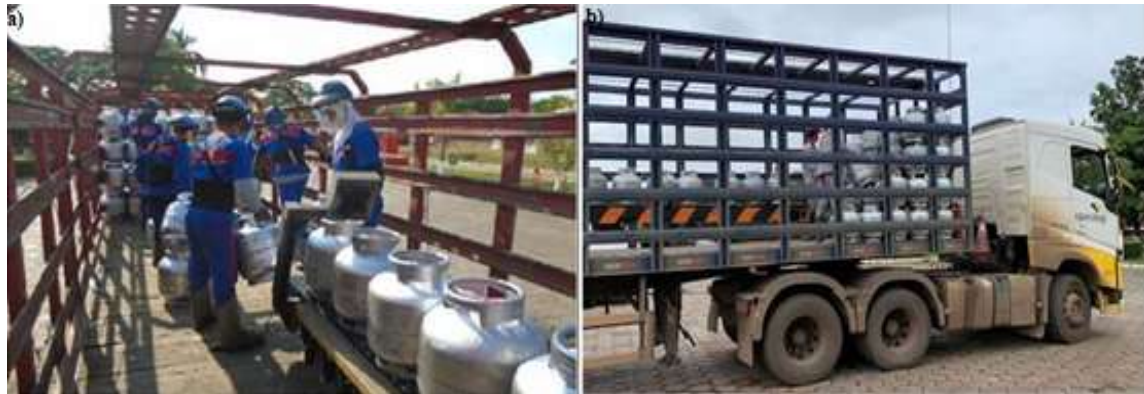
Figura 15: Realização carga de botijões na a) lança convencional e na b) lança com duplo avanço
