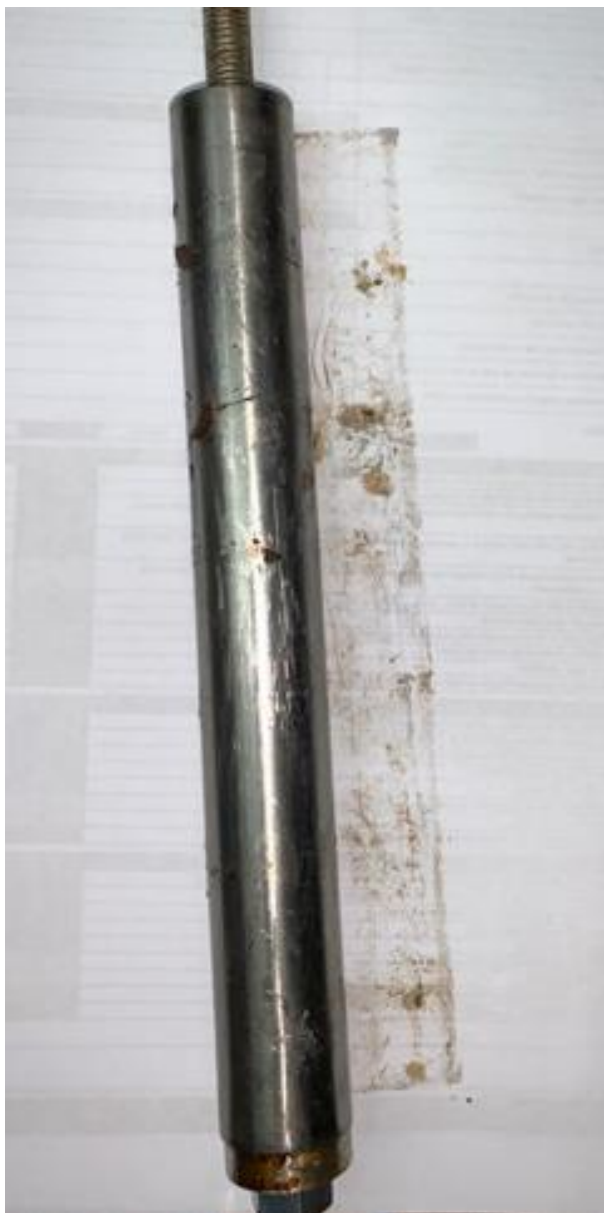
Imagem 12 – Ímã após ser retirado do filtro
