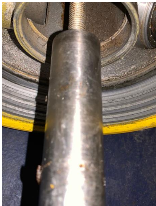
Imagem 9 – Ímã e sede da haste após retirada do elemento filtrante
