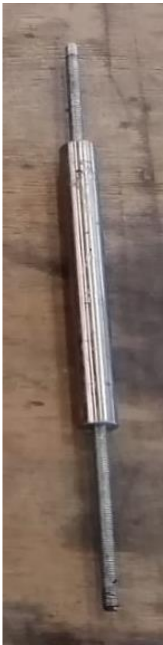
Imagem 3 – Elemento filtrante e ímã de neodímio-ferro-boro rosqueado na haste M10
