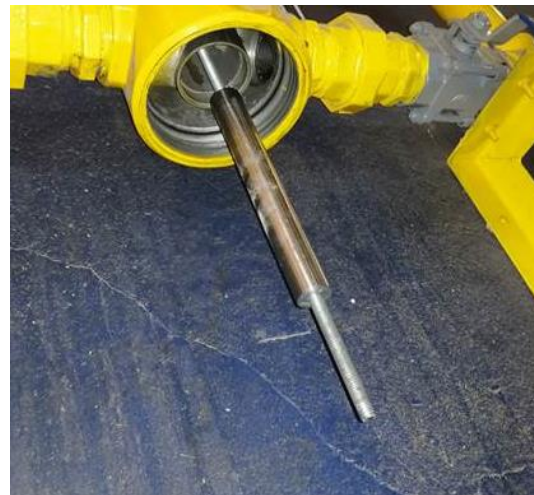
Imagem 4 e 5 – Teste de fixação da haste, com ímã, no filtro FC2
