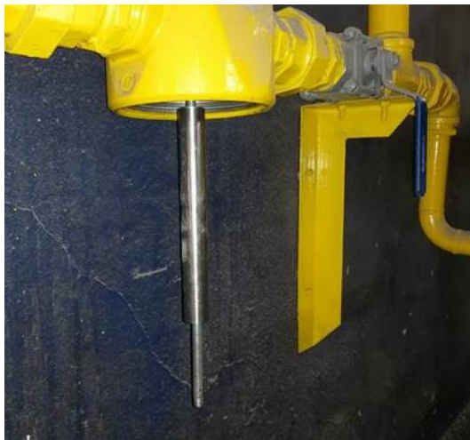
Imagem 4 e 5 – Teste de fixação da haste, com ímã, no filtro FC2
