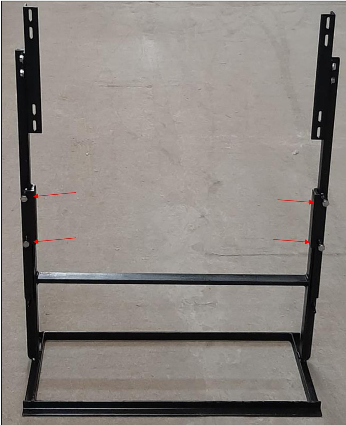
Figura 4 - Parafusos para regulagem de altura
